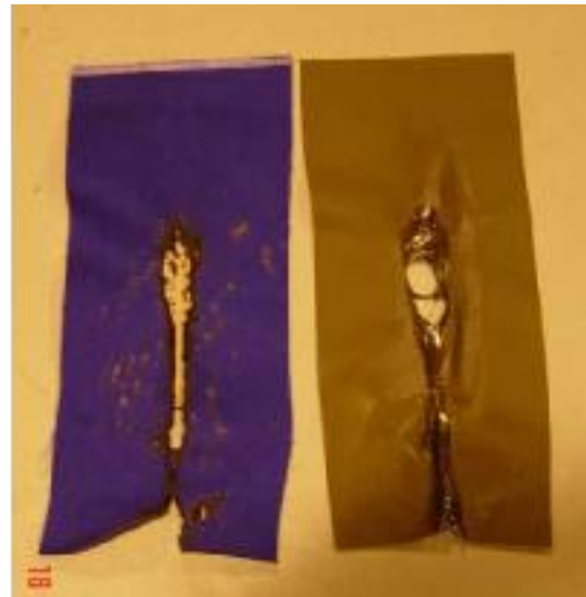
Kuvat 3 ja 4. Ensimmäisen vaiheen materiaalitesti, näytepidike ja kaato, tekoiho-malli
