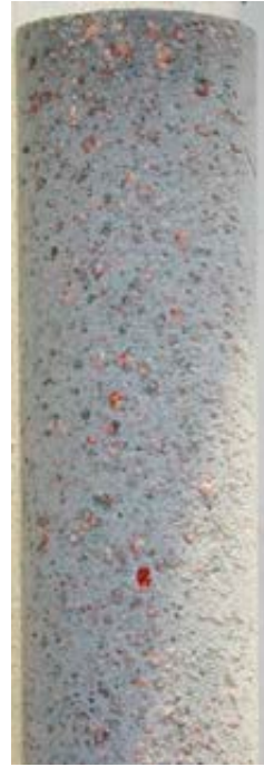
Carry-over hiukkasia sondin pinnalla. [Åbo Akademi]
