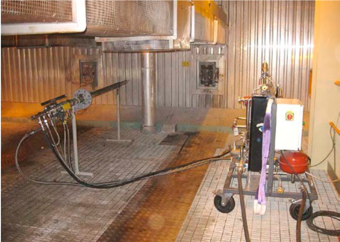
III VTT:n tulistikorroosiosondi ennen kattilaan menoa. [VTT]
