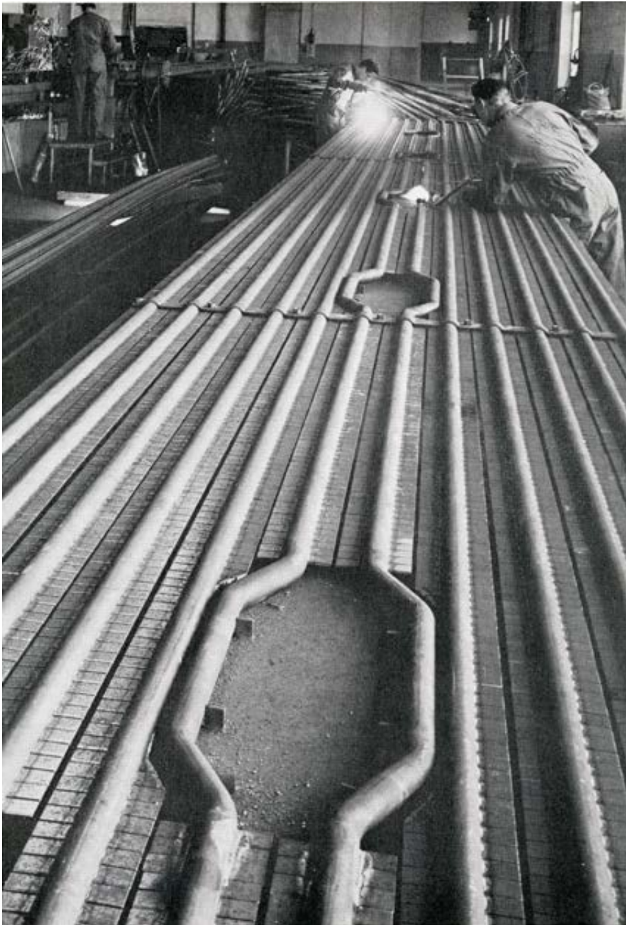
Sunilan SK10-kattilan ekonomaiserielementtien valmistusta Svenska Maskinverketin konepajalla Ruotsissa vuonna 1965. 15,5 metriä pitkät ja 1,5 tonnia painavat elementit kuljetettiin Sunilaan junalla Haaparannan kautta. [SKY]
