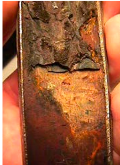
Näyte tulipesän seinäputkesta jossa vetyhyökkäys on edennyt pitkälle. [SKY]
