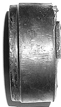
Den brustna bakänden av innerröret, ett tydligt utmattningsbrott
