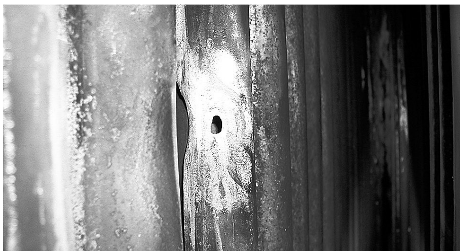
Sekundärskadan, dvs det stora hålet
