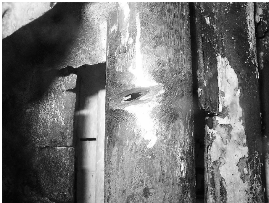
Sprickan var 20 mm lång och reparerades med TIG
