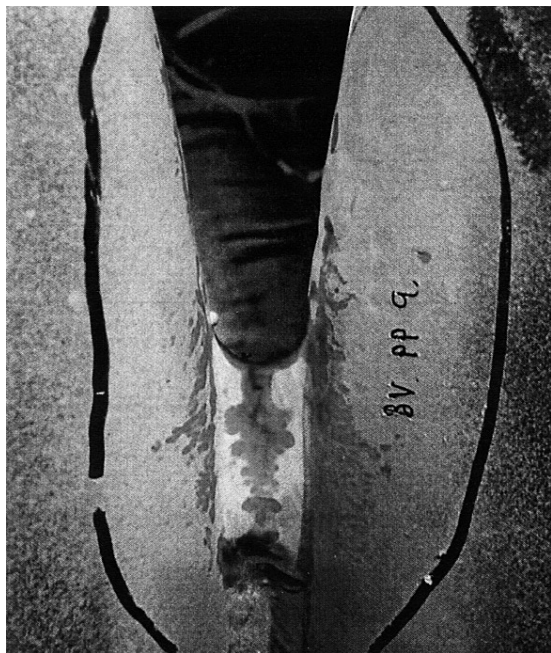
Sprickor både i skarven emellan tuberna och ute på tubytorna
