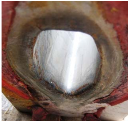
Sprickorna runt rännans öppning
