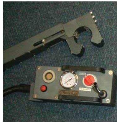
Kuva 10. Guided wave laitteiston sovelluksia lämmönvaihtimelle sekä tuubiputkistolle /Guided ultrasonics ltd/.
