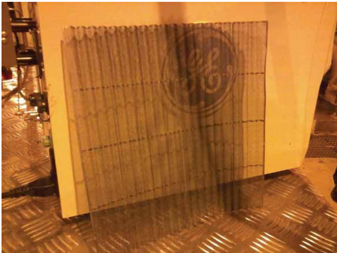
Kuva 38. Kokeissa käytetty titaanidioksidi verkkomaisella tukiaineella.
