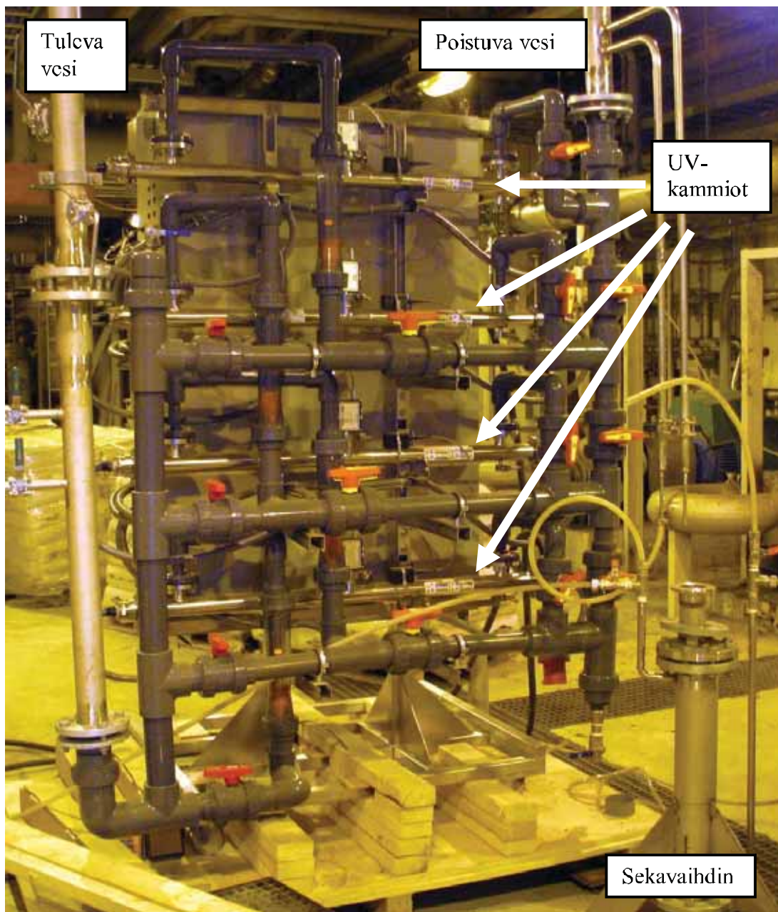
Kuva 37. UV-kokeissa käytetty pilot-laitteisto.
