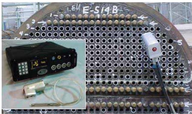
Kuva 10. Guided wave laitteiston sovelluksia lämmönvaihtimelle sekä tuubiputkistolle /Guided ultrasonics ltd/.
