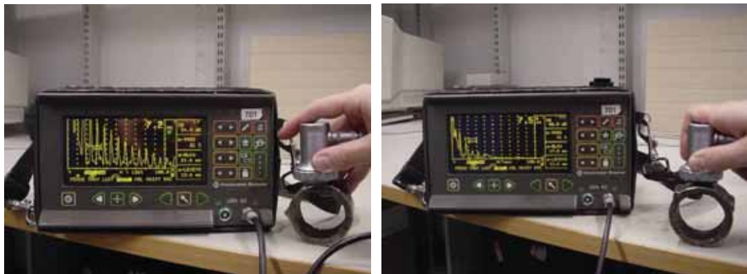
Kuva 8. A-näytöt ehjästä putkesta ja vetyhyökkäyskohdalta.
