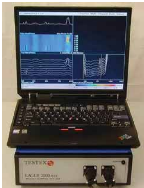
Kuva 11. RFET laitteisto putkiston tarkastukseen /Testex Incorporation/
