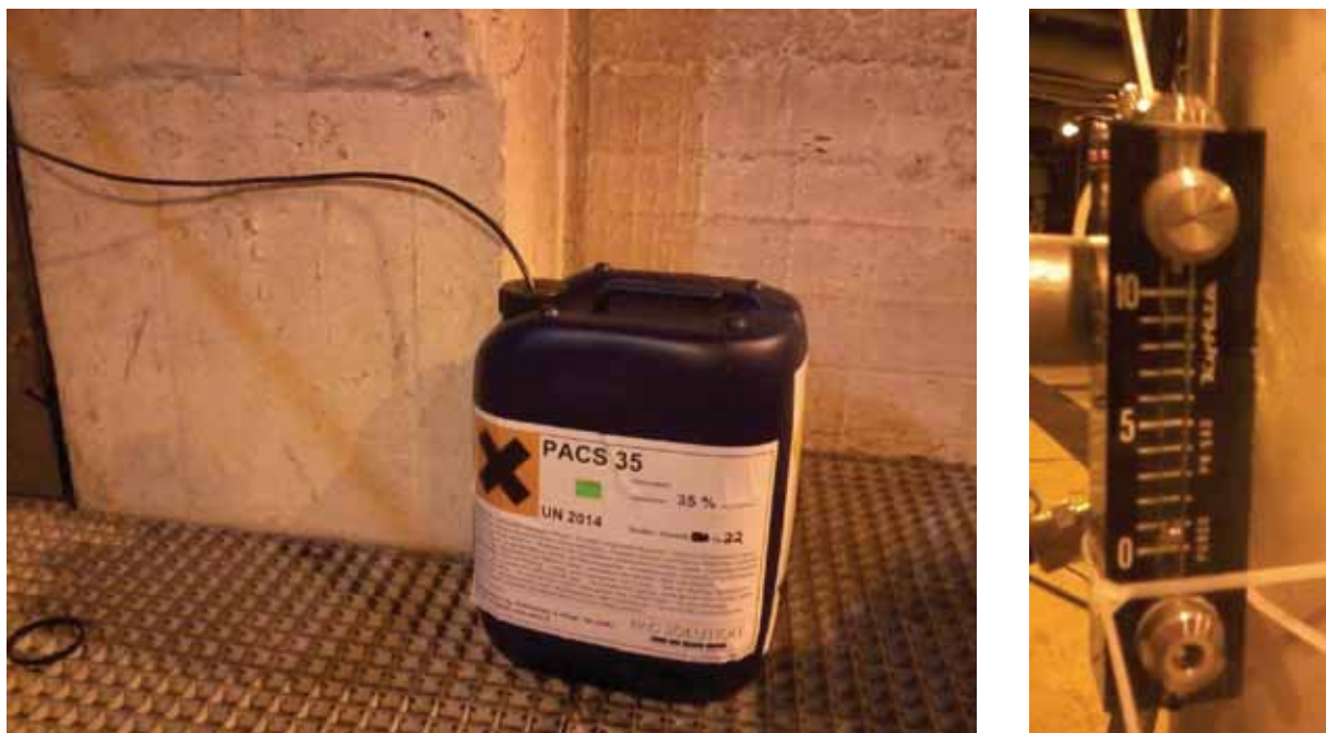
Kuva 39. Vasemmalla: kokeissa käytetyn vetyperoksidin kemikaalisäiliö. Oikealla: annostelun säädössä käytetty rotametri.
