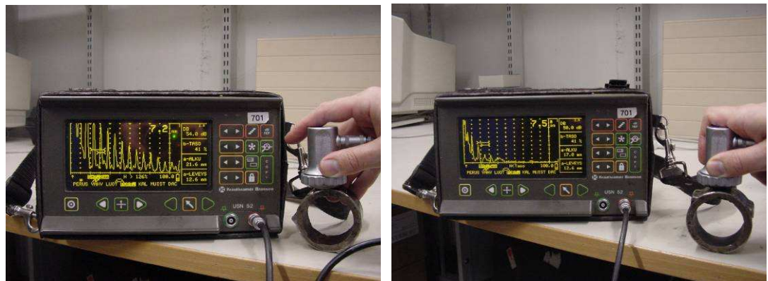
Kuva 8. A-näytöt ehjästä putkesta ja vetyhyökkäyskohdalta.
