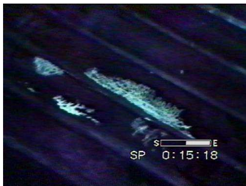
Kuva 3. Fluoresoivalla tunkeumanesteellä tarkastetun pohjan särönäyttämiä
