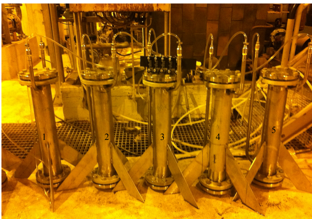
Kuva 1. Aktiivihiilien vertailukokeiden tutkimuslaitteisto. Käytetyt aktiivihiilet olivat 1. GAC 1240 PLUS, 2. CPG-LF 1, 3. AQUACARB 607C, 4. GCN 1240, 5. CPG-LF 2. Taulukko 1. Aktiivihiilien vertailukokeissa käytettyjen aktiivihiilten tekniset tiedot.
