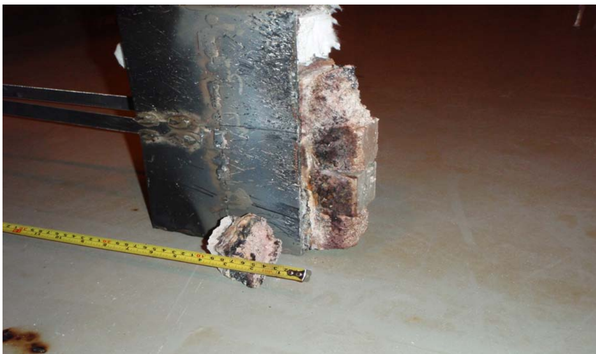
Kuva 2. Omatekoinen valmista spinelliä sisältävä massa ei ollut mekaanisesti tarpeeksi lujaa vaan katkesi kehikkoa irrotettaessa. Molemmat tiilet näyttävät hyviltä verattuna alinna vertailumateriaalina olevaan hasslen massa.
