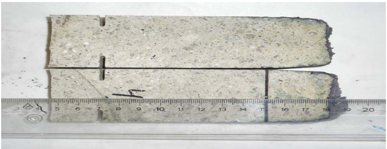
Kuva 3. Hassle B1800 on turvonnut soodakattila sulan tunkeutumisen johdosta. Pinta näyttää lohkeilevan, samoin joitain halkeamia näkyy. Sula on tunkeutunut yli puolenvälin tiiltä.
