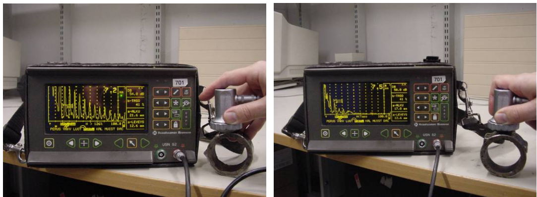
Kuva 8. A-näytöt ehjästä putkesta ja vetyhyökkäyskohdalta.
