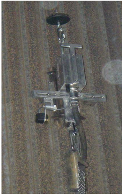
Kuva 6. T-scan laitteisto kattilan seinällä
