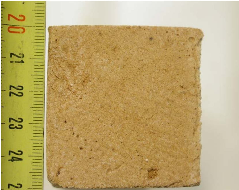
Kuva1. Oma massa kokeessa1. Syntetisoitu forsteriitti. Tehty kiinalaisesta magnesiasta ja nilsiän kvartsista. Sidokseen käytettiin kolloidista silikaa sekä puhdasta erittäin hienorakeista magnesiumoksidia. Synteesi tehty 1500°C 2h. Mittoja 50x50x150mm. Poltossa hieman käyrästynyt ja halkeillut.
