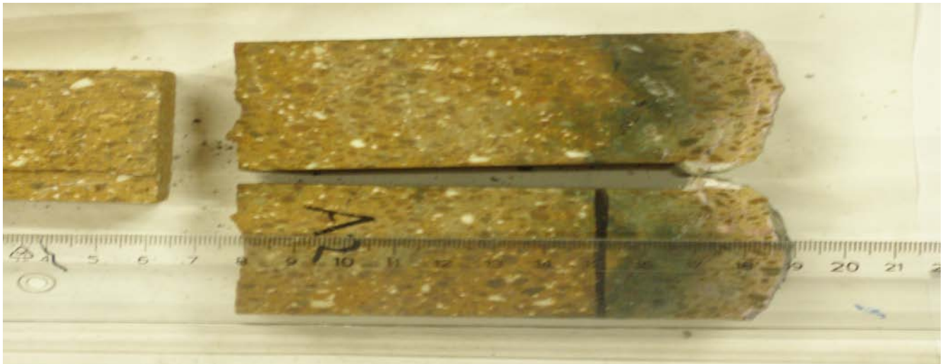
Kuva 7. MgO-rauta tiilessä sula on tunkeutunut noin 50 mm. Tiilen pinta on melko pyöreä.
