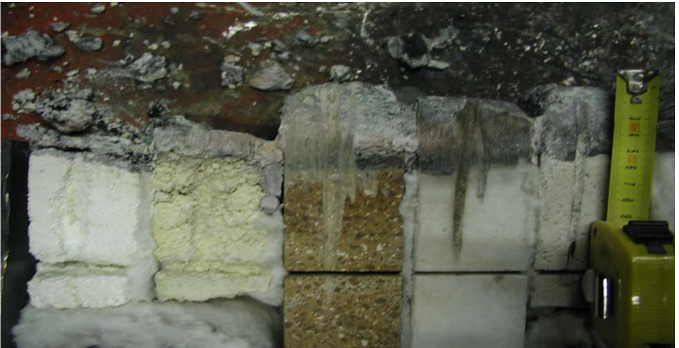
Kuva 3. Massoista parhaiten on pärjännyt alinna oleva hassle kuluma noin 10 mm. Seuraavana betker on jo huomattavasti enemmän kulunut. Siitä seuraava forsteriitti , ZrO_2 ja Ankoflo.
