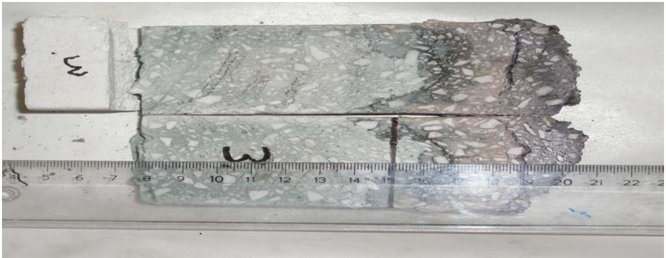
Kuva 3. Hassle B1800 on turvonnut soodakattila sulan tunkeutumisen johdosta. Pinta näyttää lohkeilevan, samoin joitain halkeamia näkyy. Sula on tunkeutunut yli puolenvälin tiiltä.
