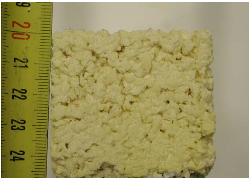
Kuva 2. Oma massa. Valmis-spinelliä magnesarikasta + \text{CeO}_2 + kalsiumaluminaattisementtiä 2%. 50x50x148mm
