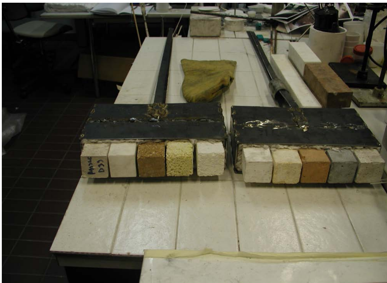
Kuva 1. Molemmat valmiit kehiöt. Kappaleiden ulkonema oli 50 mm.
