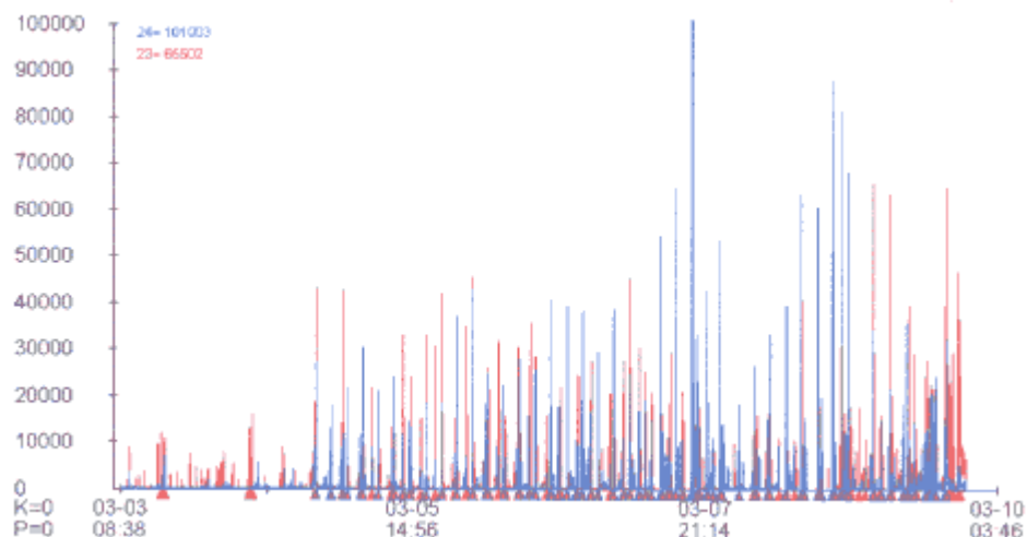
Kuva 18. Acutestin järjestelmän tuloste II ekonomaiserin jakotukin antureilta Joutsenosta ajanjaksolta 3.3. - 10.3.1999.
