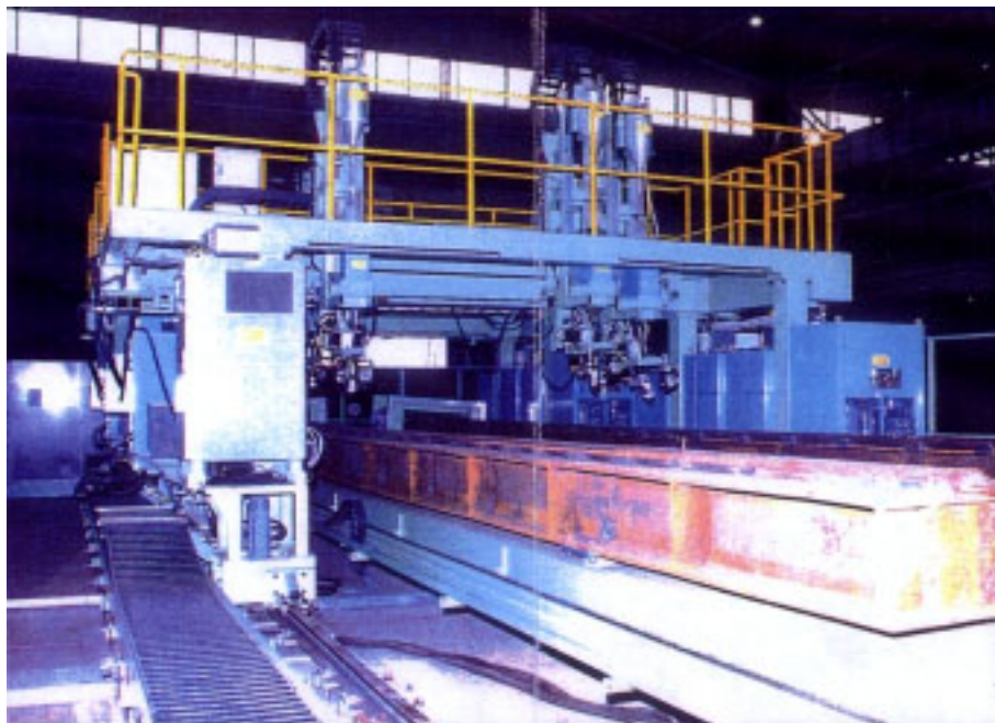
Kuva 20 Kokonaisten seinäpanelien robotisoituun hitsaukseen käytetty PTAW-hitsausasema MHI:ssa, jossa kokonaista paneelia voidaan kallistaa hitsauksen edetessä [Mitsubishi, 2002].
