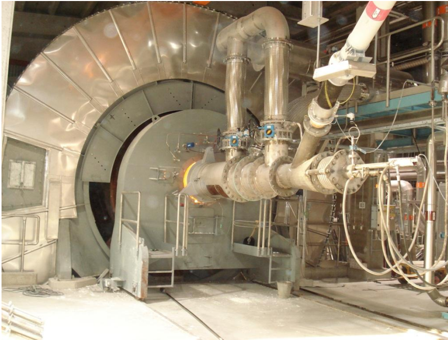
Brännare för träpulver, olja och svavelgas i Mesaugn
