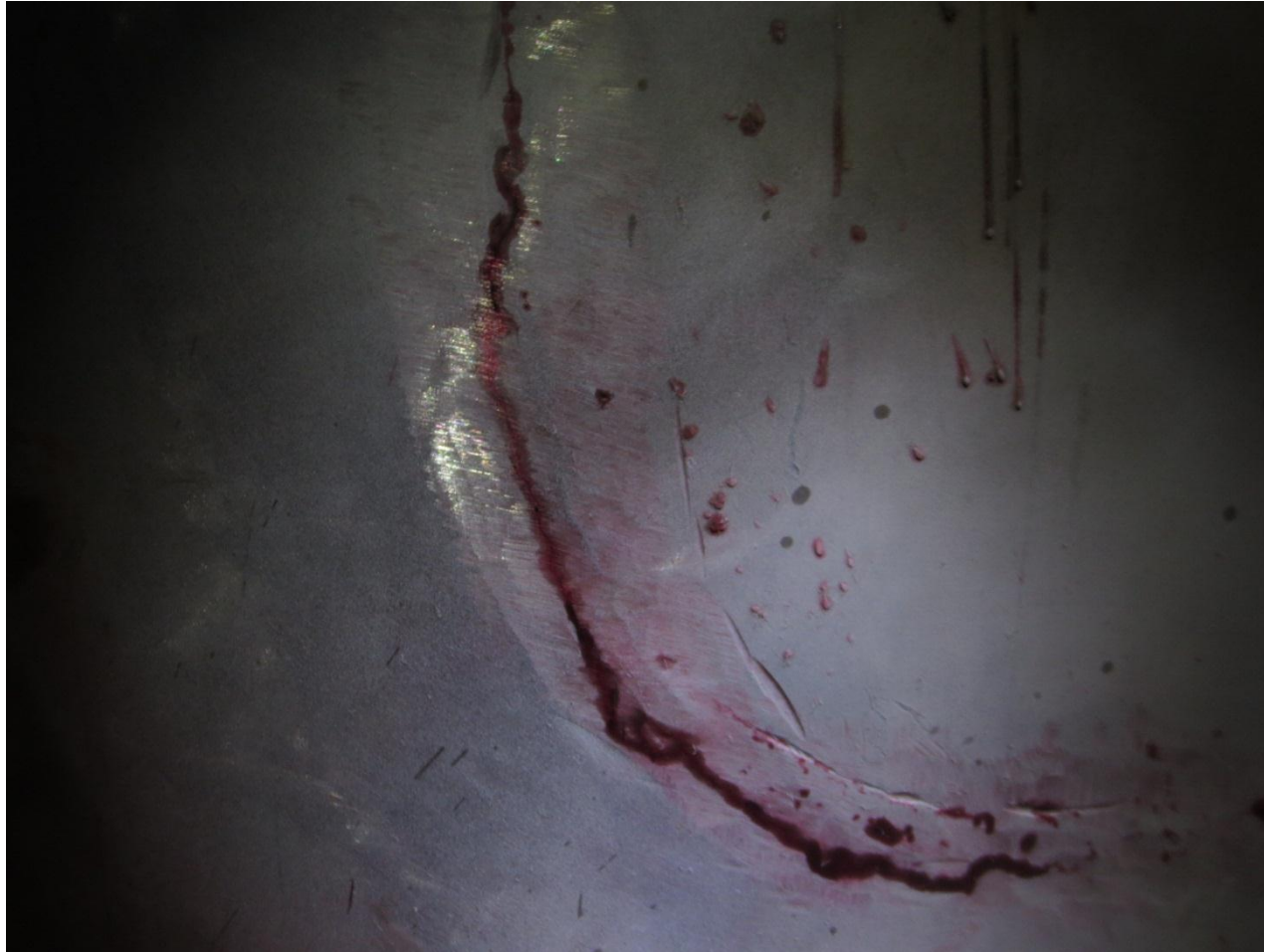
Närbild på en av sprickorna efter utförd penetrantprovning
