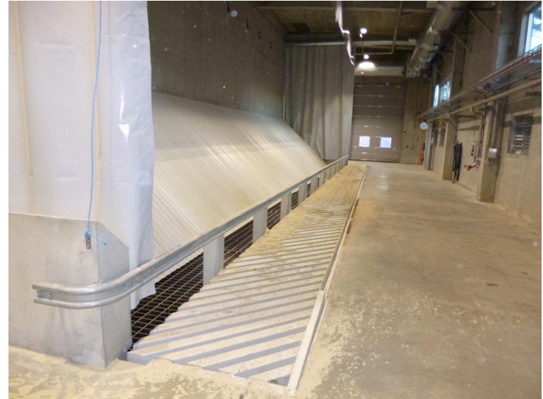
Mottagningsficka pellets
