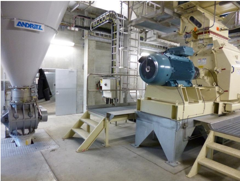
Hammarkvarn för malning till pulver och cyklonavskiljare luft/pulver
