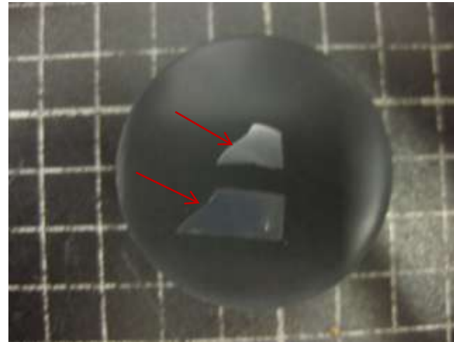
Snitt för metallografisk undersökning, brottkanten löper ca 2 mm från svetsens smältgräns
