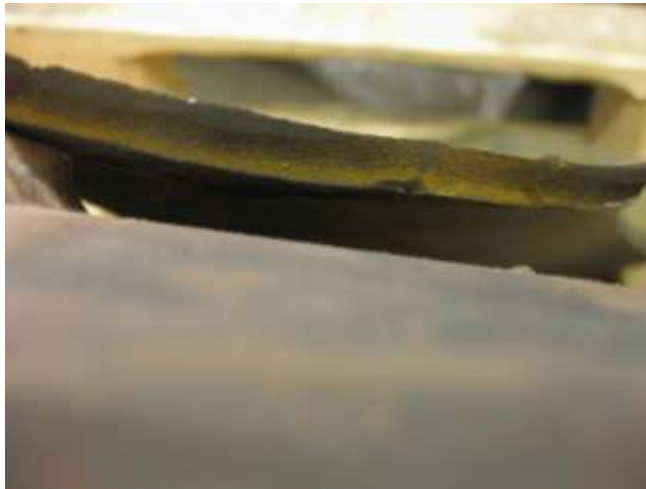
Driftinducerad brottyta på anslutande rördel
