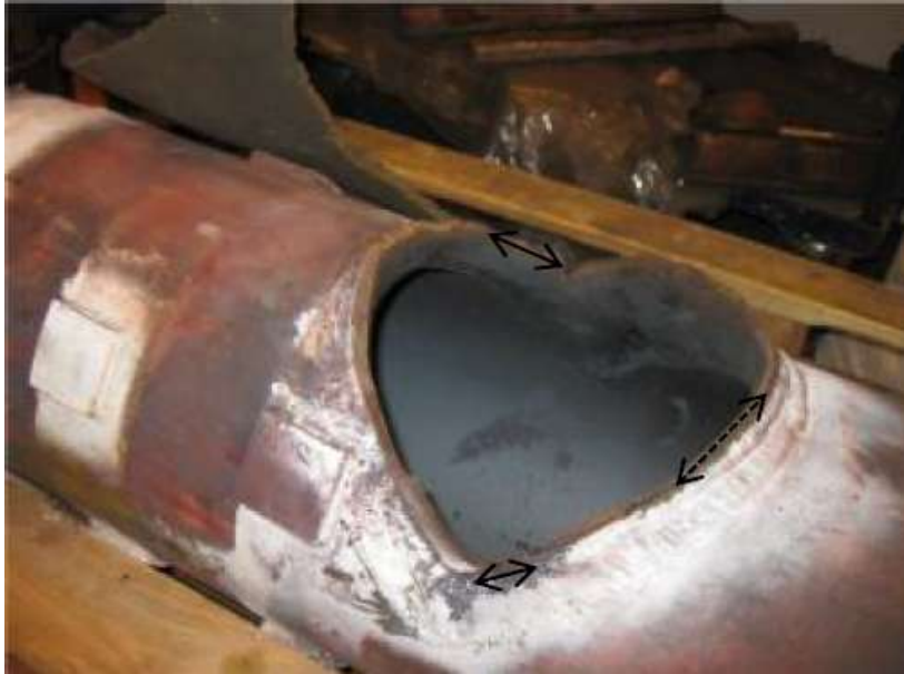
Driftinducerad spricktillväxt vid pilar
