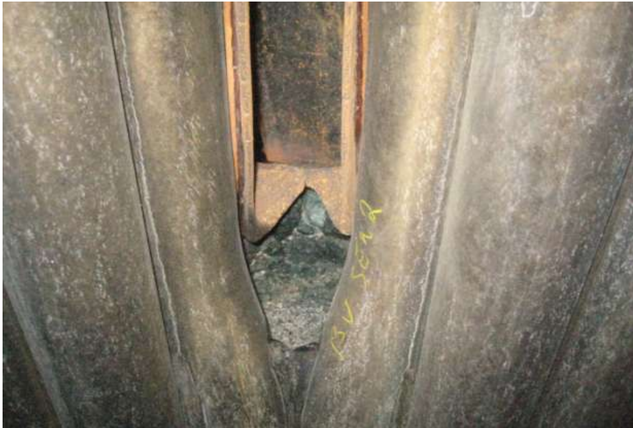
Gjutjärnsdysa kraftigt bränd i nedre delen
