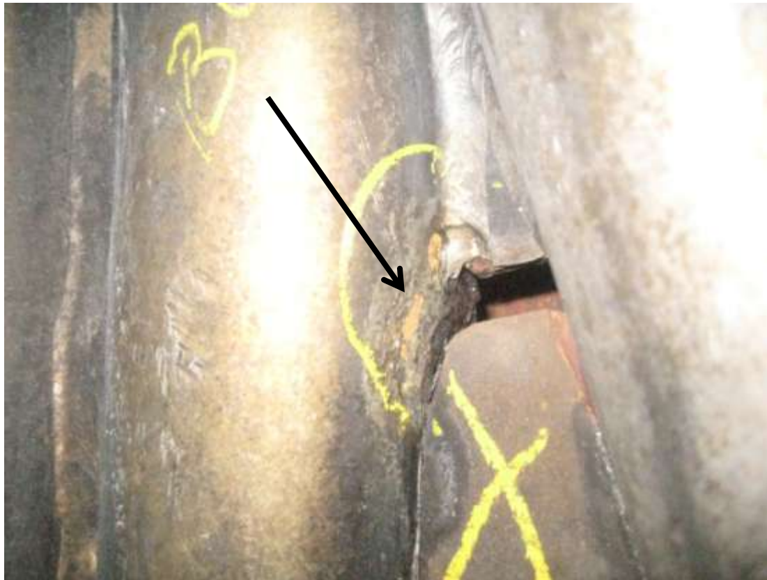
Gjutjärnsdysa bränd i överkant och korrosion på tuben.
