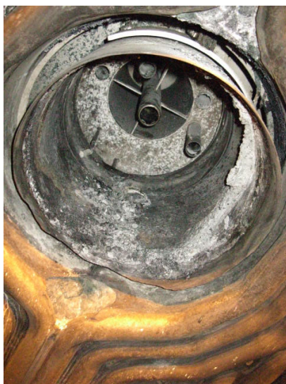
Kuva 7-37-3. Eräs väkevien hajukaasupoltin kuvattuna kattilan sisältä ja ulkoa.
