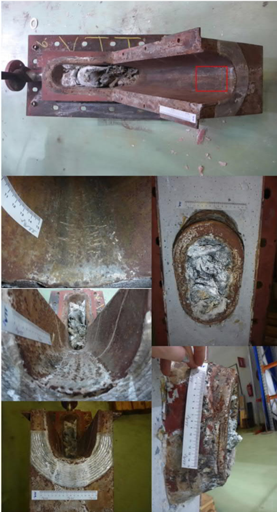
Kuva 145. Tutkimuksiin toimitettu kouru (Äänekoski 6). Säröytynyt alue on merkitty yllimpään kuvaan punaisella suorakaiteella.
