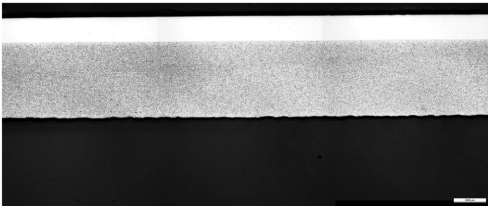
Kuva 131. Pietarsaaren uuden sulakourun poikkileikkaus seinämältä
