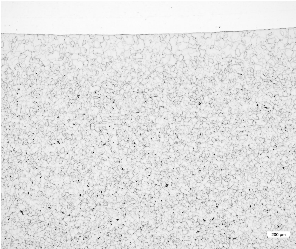
Kuva 16. Kaukopää SK5 pinnoite-perusainerajapinta sulakourun pohjalta, perusaine syövytetty
