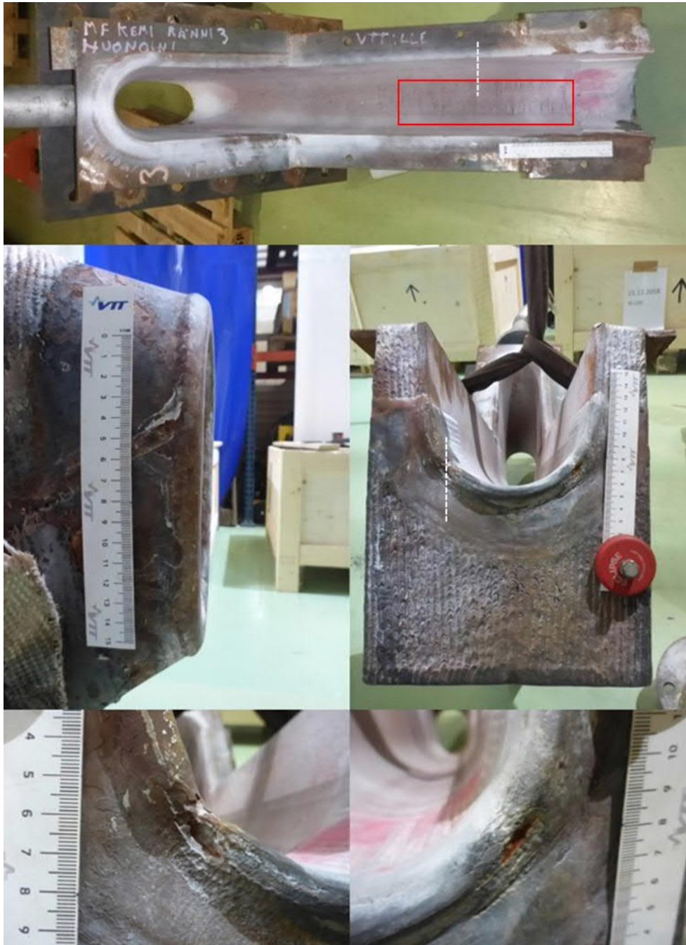
Kuva 38. Tutkimuksiin toimitettu kouru (Kemi 3). Säröytynyt alue on merkitty yllimpään kuvaan punaisilla suorakaiteilla. Poikkileikkaushieiden paikat ovat merkitty kuviin valkoisella katkoviivalla.
