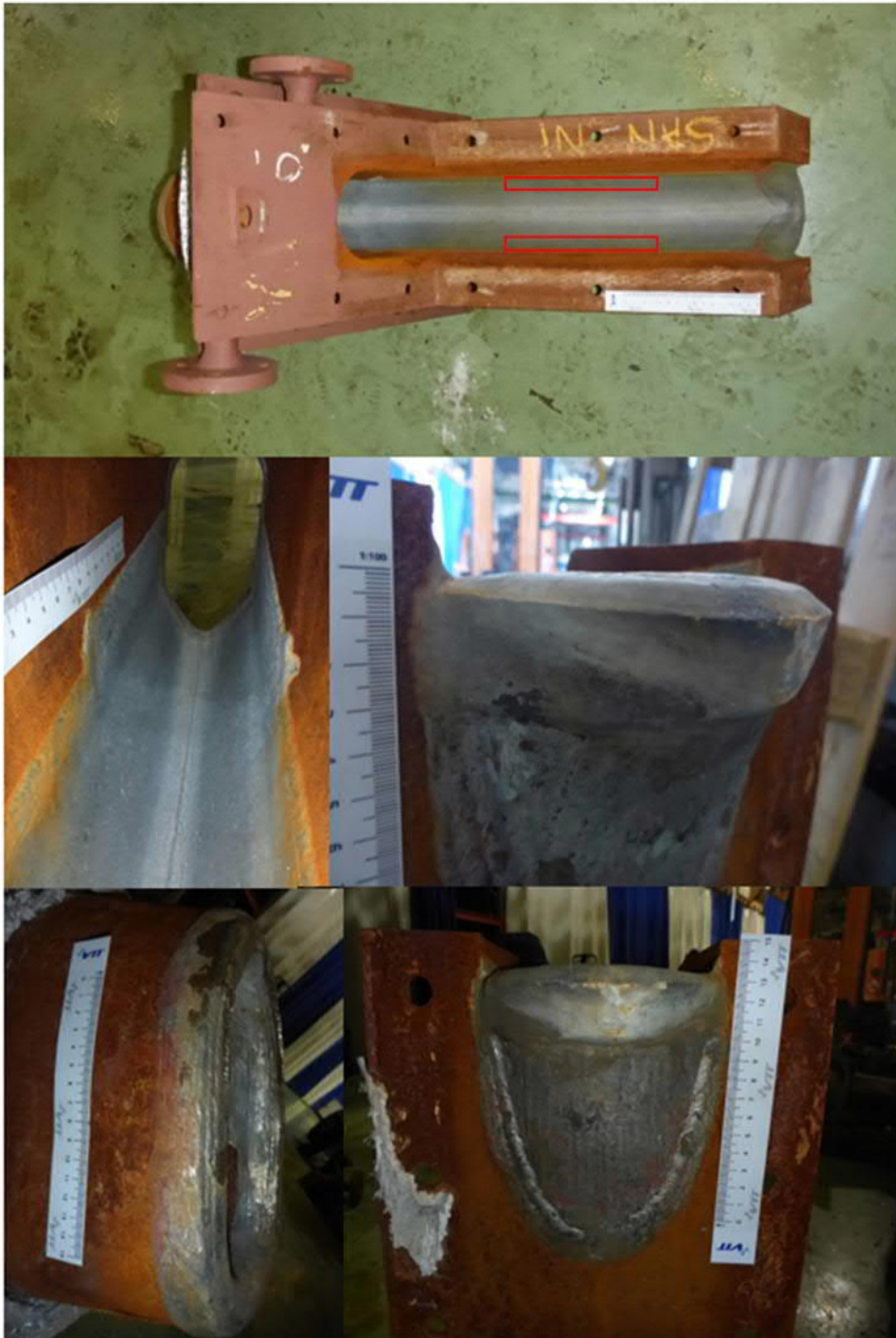
Kuva 9. Tutkimuksiin toimitettu sulakouru (Joutseno 6). Havaitut säröalueet merkitty yllimpään kuvaan punaisilla suorakaiteilla.
