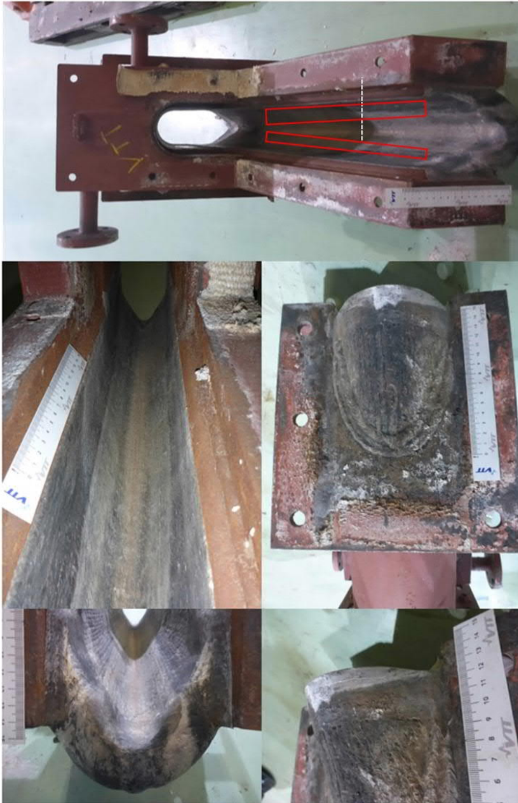
Kuva 106. Tutkimuksiin toimitettu kouru (Pietarsaari Y). Säröytyneet alueet merkitty yllimpään kuvaan punaisilla suorakaiteilla. Poikkileikkaushieen paikka on merkitty kuvaan valkoisella katkoviivalla.
