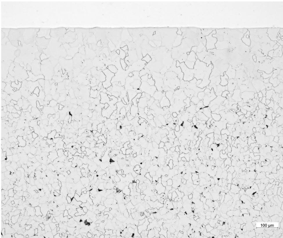
Kuva 22. Kaukopää SK5 pinnoite-perusainerajapinta sulakourun seinämältä, perusaine syövytetty
