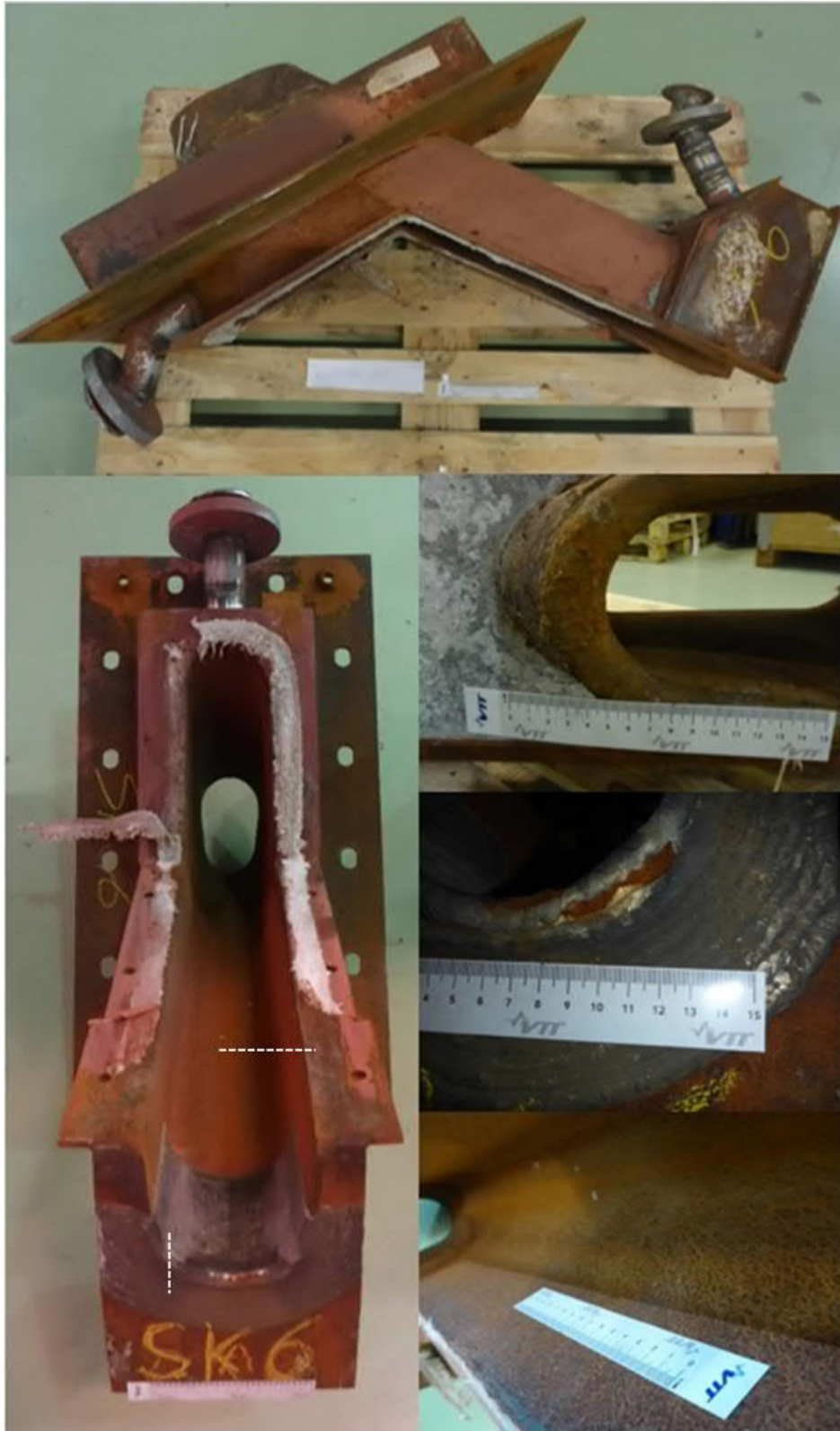
Kuva 13. Tutkimuksiin toimitettu kouru (Kaukopää SK6). Poikkileikkaushieiden paikat ovat merkitty vasempaan alakuvaan valkoisella katkoviivalla.
