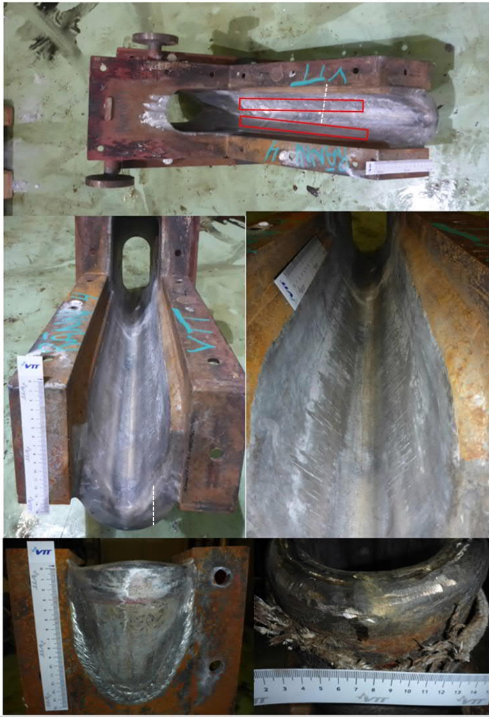
Kuva 77. Tutkimuksiin toimitettu sulakouru, Oulu 4. Säröytyneet alueet onmerkitty yllimpään kuvaan punaisilla suorakaiteilla. Jättöpään poikkileikkausnäyte on tehty valkoisen katkoviivan kohdalta.
