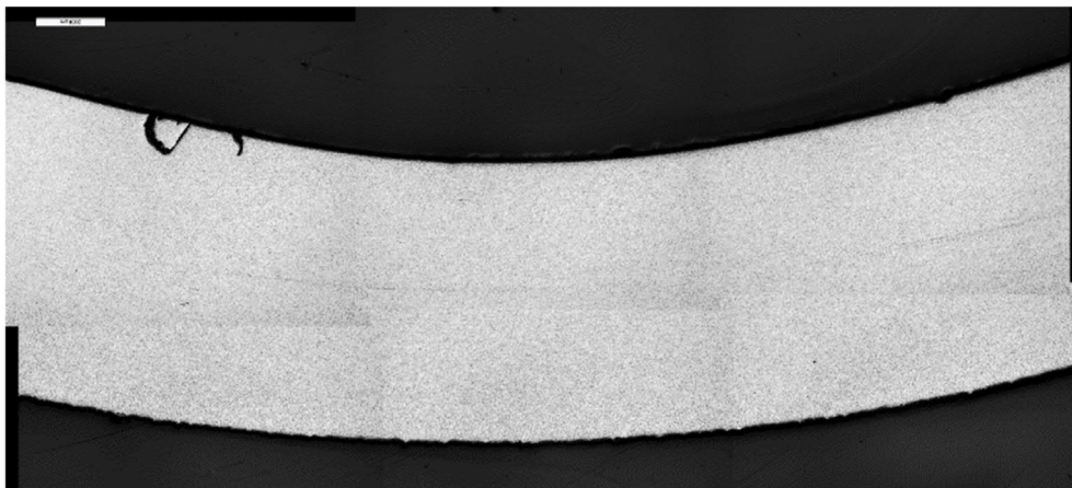
Kuva 57. Kemi 5 poikkileikkaus kourun pohjalta, sisäpinta (vesikierron puoleinen pinta) alhaalla
