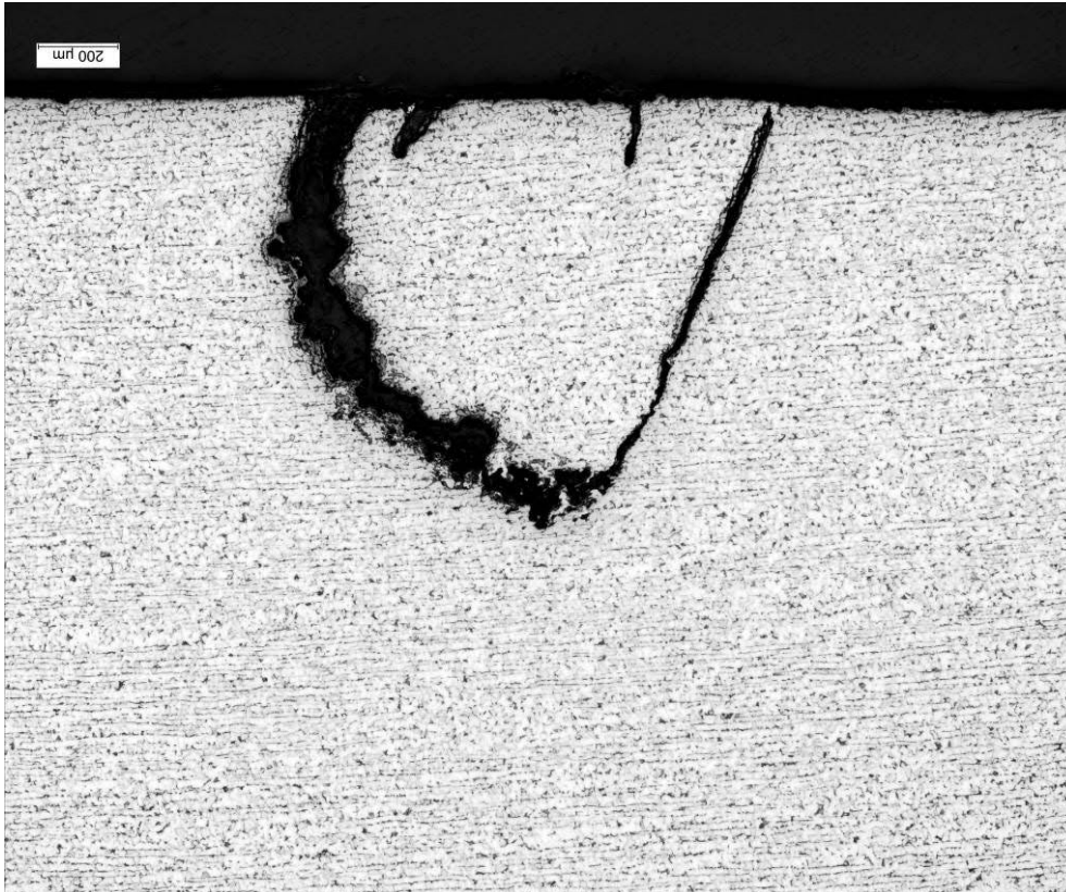
Kuva 58. Kemi 5 särö kourun pohjan ulkopinnalla
