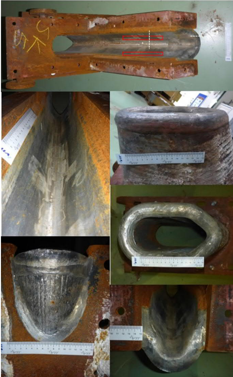
Kuva 12. Tutkimuksiin toimitettu kouru (Kaukopää SK5). Säröytyneet alueet merkitty yllimpään kuvaan punaisilla suorakaiteilla. Poikkileikkaushieiden paikat ovat merkitty kuvaan valkoisella katkoviivalla.
