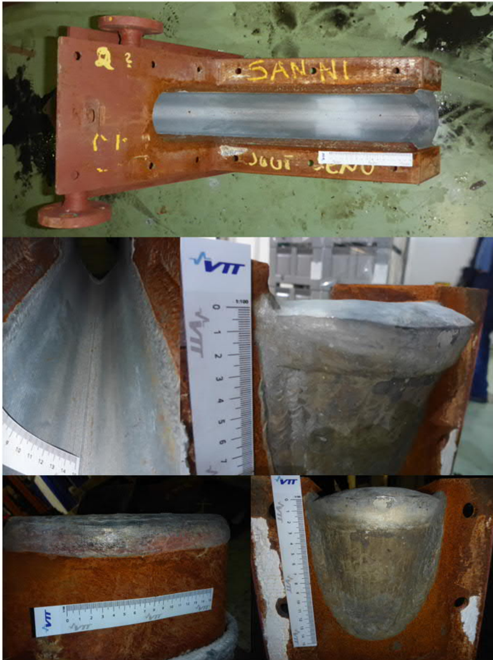
Kuva 8. Tutkimuksiin toimitettu sulakouru (Joutseno 2)
