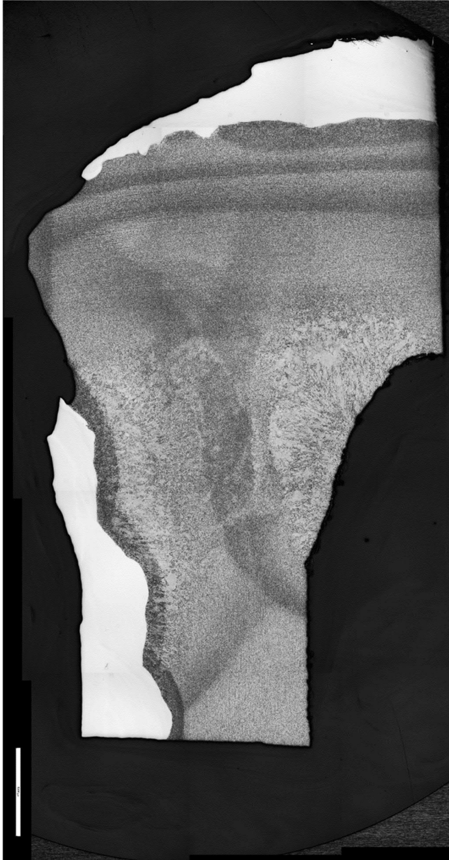
Kuva 49. Kemi 3 sulakourun jättöpään poikkileikkaus
