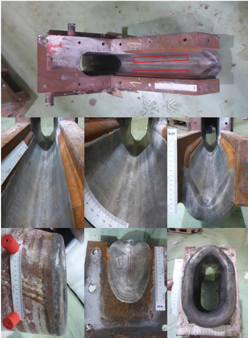
Kuva 142. Tutkimuksiin toimitettu kouru (Veitsiluoto 1). Säröytyneet alueet on merkitty yllimpäin kuvaan punaisilla suorakaiteilla.
