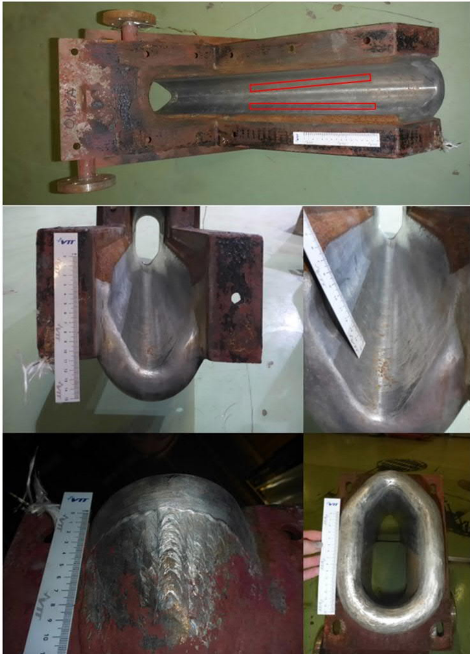
Kuva 71. Tutkimuksiin toimitettu kouru (Kotkamills oikea). Säröytyneet alueet on merkitty yläkuvaan punaisilla suorakulmioilla.
