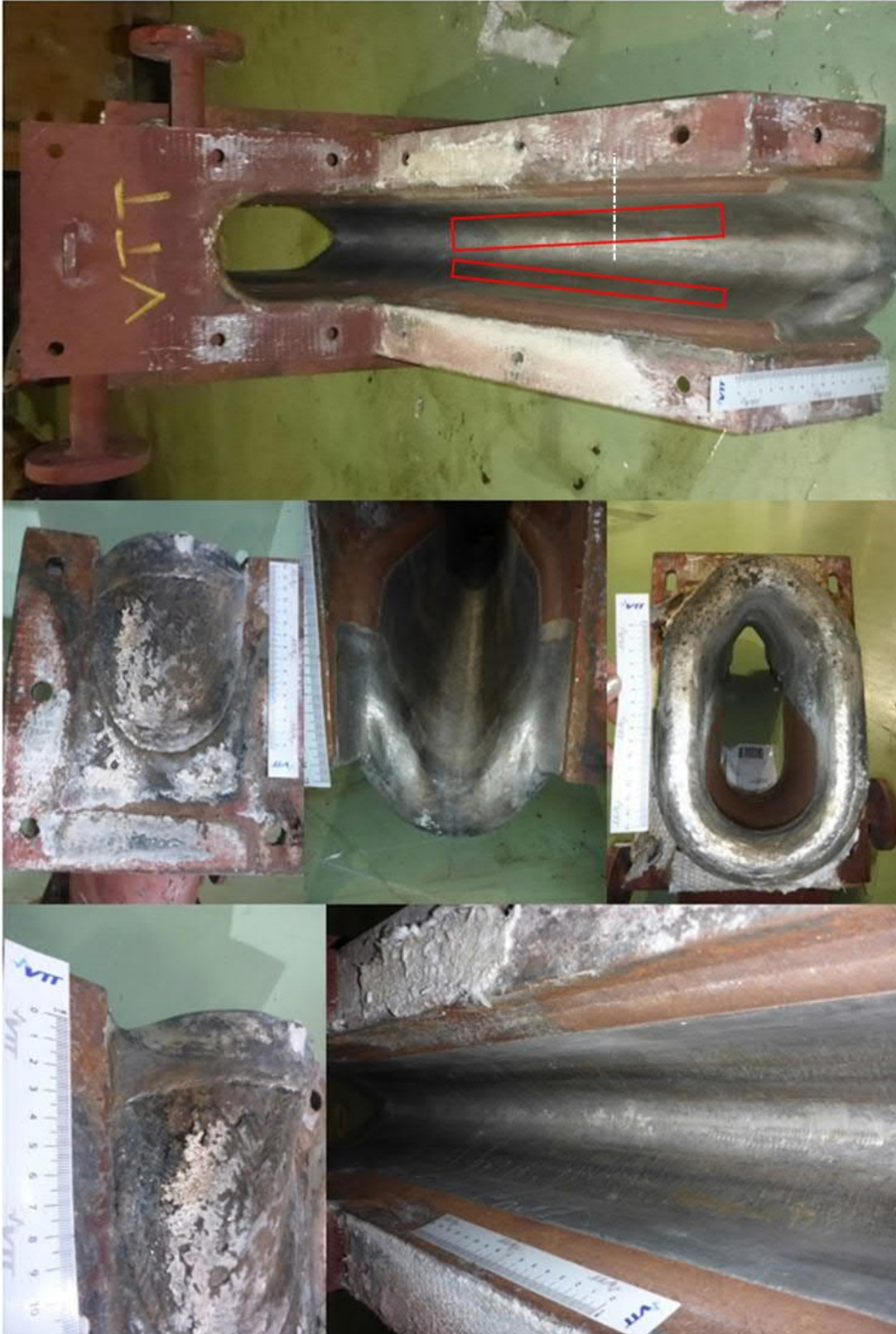
Kuva 105. Tutkimuksiin toimitettu kouru (Pietarsaari X). Säröytyneet alueet on merkitty ylläpään kuvaan punaisilla suorakaiteilla. Poikkileikkaushieen paikka on merkitty kuvaan valkoisella katkoviivalla.
