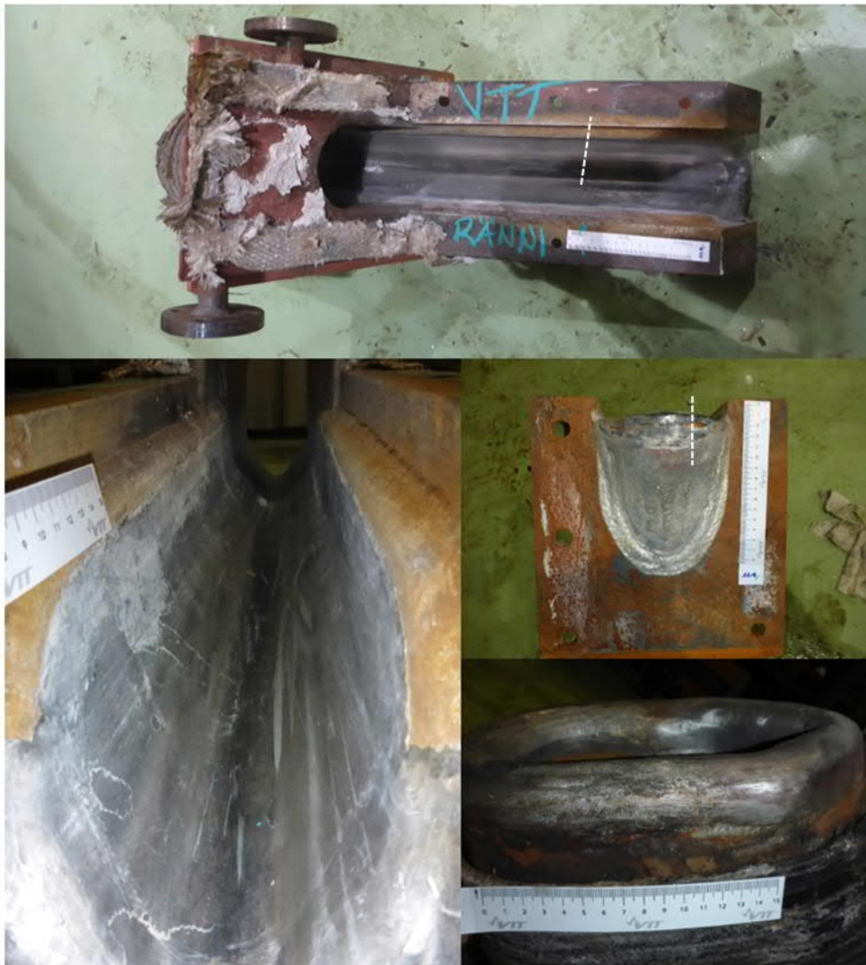
Kuva 75. Tutkimuksiin toimitettu sulakouru, Oulu 1. Näytteiden ottopaikat on merkitty valkoisilla katkoviivoilla kuviin.
