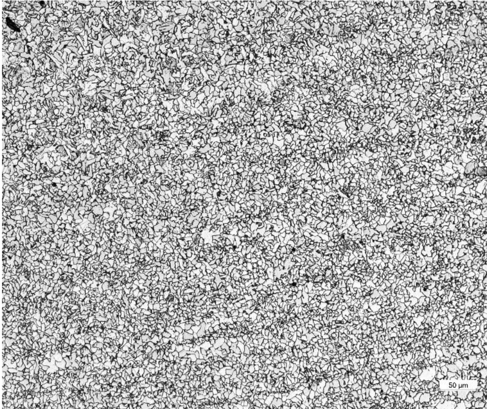
Kuva 121. Pietarsaari Y, perusaineen mikrorakenne kourun pohjalta
