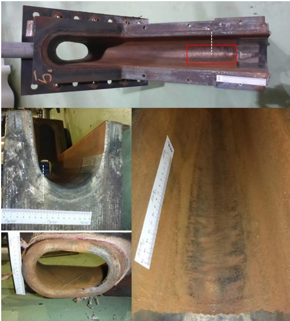
Kuva 40. Tutkimuksiin toimitettu sulakouru (Kemi 5). Säröytyneet alueet merkitty ylimpään kuvaan punaisilla suorakaiteilla. Poikkileikkaushieiden paikat ovat merkitty kuviin valkoisella katkoviivalla.
