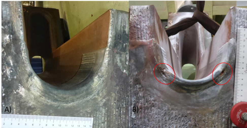
Kuva 148. Valmetin sulakourun jättöpääty a) jouhevampi jättöpinta, ja b) jyrkempi jättöpinta. Myös yleisimmät syöpymien ilmentymispaikat merkitty
