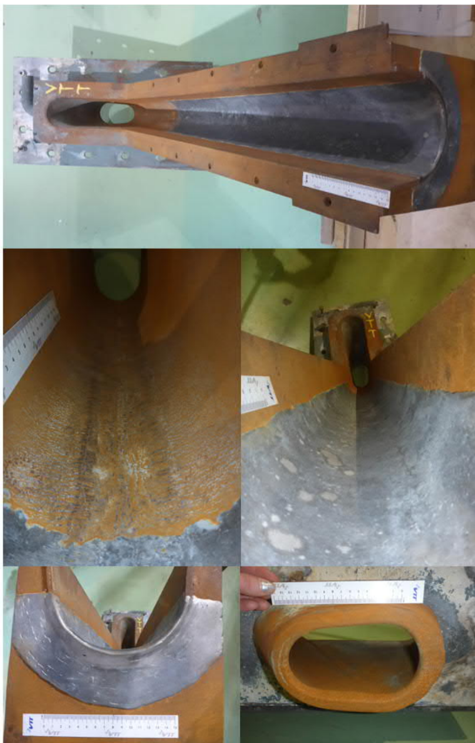
Kuva 140. Tutkimukseen toimitettu kouru (Sunila SK10)
