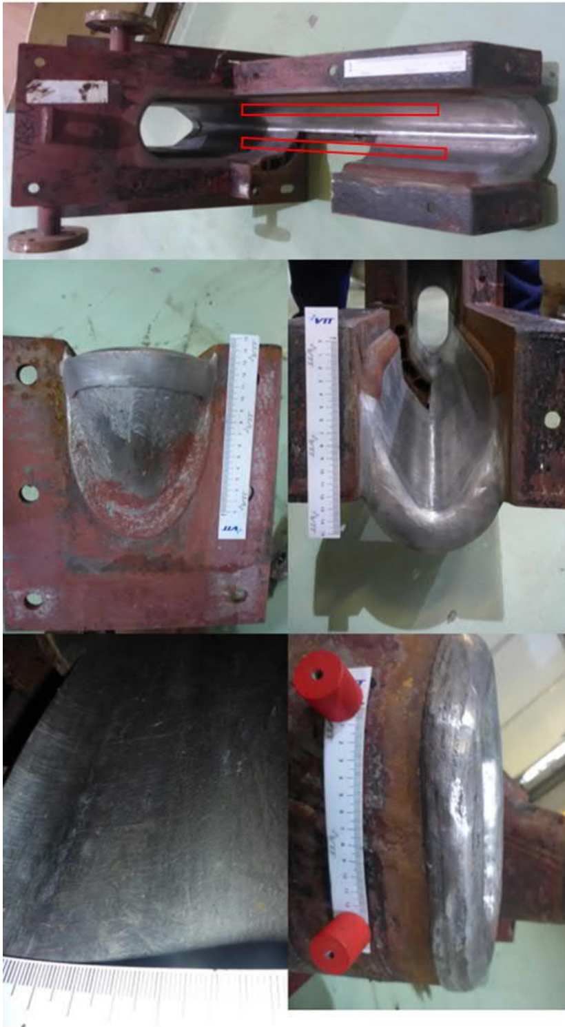
Kuva 72. Tutkimuksiin toimitettu kouru (Kotkamills vasen). Säröytyneet alueet on merkitty ylimpään kuvaan punaisilla suorakulmioilla.
