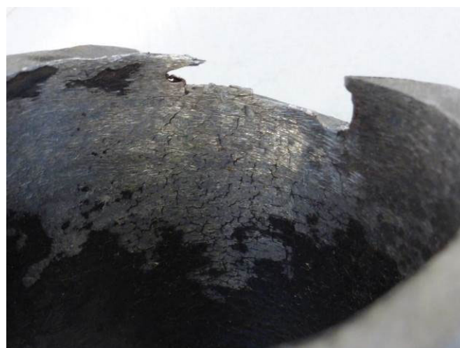
KORROOSIOVÄSYMÄNEN / TERMISET SHOKIT
