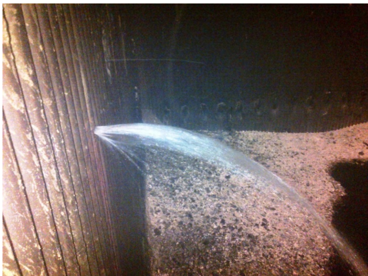
Kuvat 12 ja 13. Suuri vuoto aasialaisen soodakattilan seinäputkessa sekä lähikuva vaurioituneesta seinäputkesta
