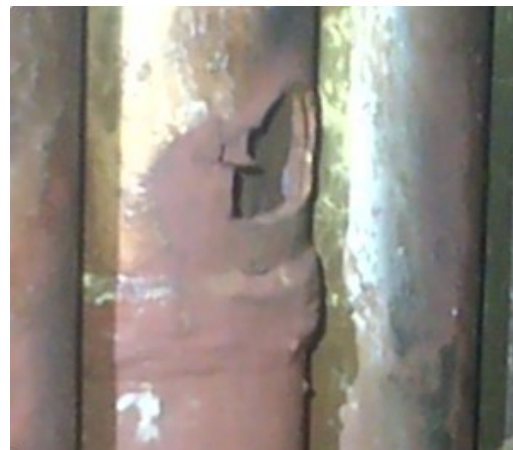
Kuvat 12 ja 13. Suuri vuoto aasialaisen soodakattilan seinäputkessa sekä lähikuva vaurioituneesta seinäputkesta
