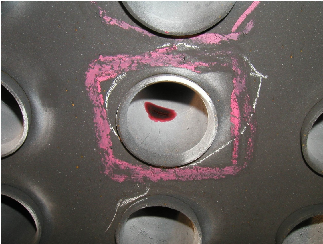
Kuva 7. Pieni särö keittopinnan putkessa 29.3.2004 Sunilan soodakattilassa SK10
