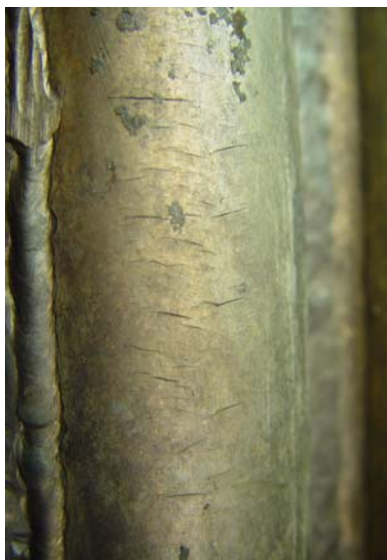
Kuva 1. Tyypillistä säröilyä primääriaukon ohituksessa. Suoria, ”avoimia” säröjä. Termisen väsymisen osuus suuri.
