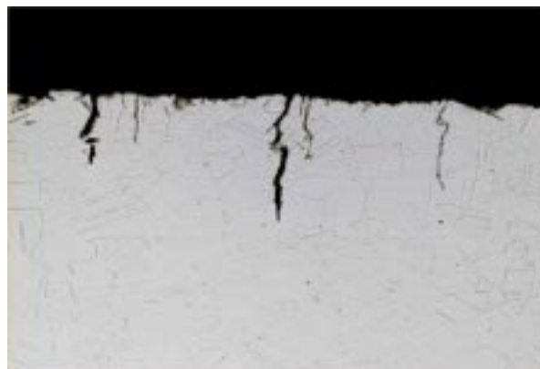
b) TGSCC, suurin särönsyvyys 850\mu\text{m} , 20% \text{Na}_2\text{S} -80% \text{Na}_2\text{CO}_3 , T_{\text{max}} = 230^\circ\text{C} , koeaika 2,5h
