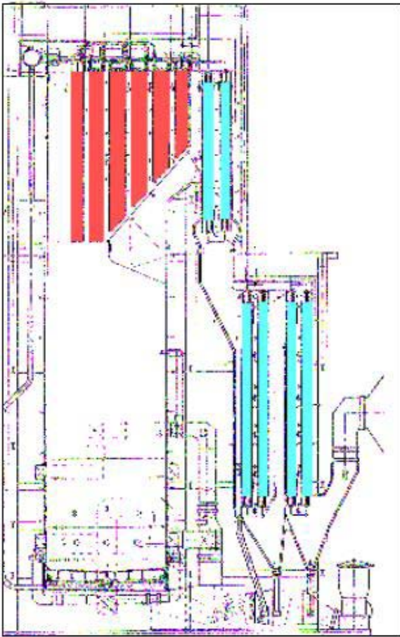
Kuva 13. Vasen kuva: Oji Paperin uusi Mitsubishin soodakattila. (Oikea kuva Nippon Paperin Kawasaki soodakattila Iwakunin tehtaalla) Tranin ja Arakawan mukaan.
