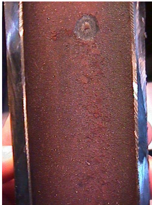
Kuva 10. Näyte Kotkan kattilan tulipesän seinäputkesta noin 2 m pohjasta.
