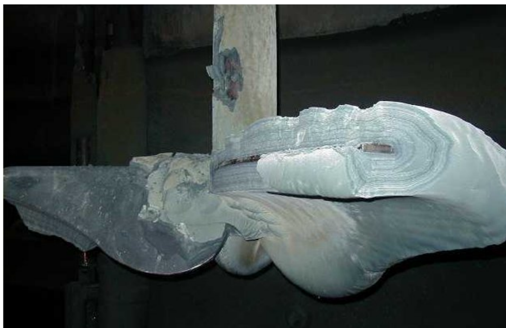
Kuva 5.2. Tyypillinen pirssoniitin aiheuttama kerrostuma liuotussäiliön sekoittajassa.
