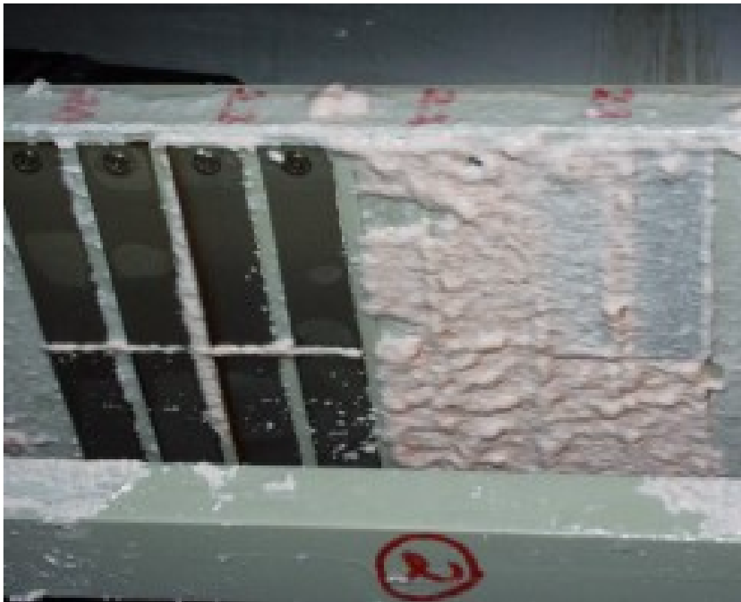
Kuva 3.6. Valokuva testilaitteistosta missä vasemmanpuoleiset koepalat ovat sähkökäsittelyjä, mutta oikeanpuoleiset eivät ole.
