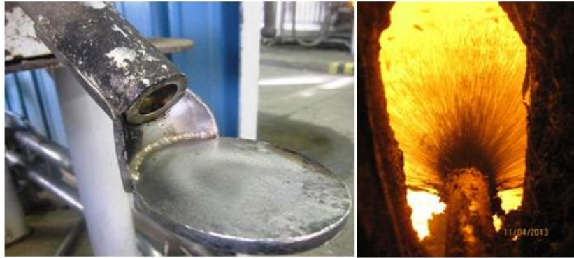
Kuva 10. Lusikkasuutin ja mustalipeän pisaroituminen. (Vihavainen, E. 2013, 26)
