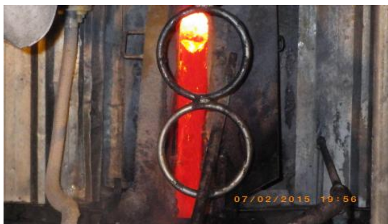
Kuva 47. Tasainen ja hyvä sulavirtaus, sulakouru aukko ei ole tukossa.
