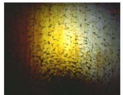
Kuva 11. Polttolipeän lämpötilan vaikutus pisaran muodostumiseen. Vasemmalla aallon muodostuminen, keskellä reikiintyminen ja oikealla paisuminen. \Delta T_e kuvaa lämpötilaeroa kiehumispisteeseen. (Miikkulainen, P. 2006, 24)
