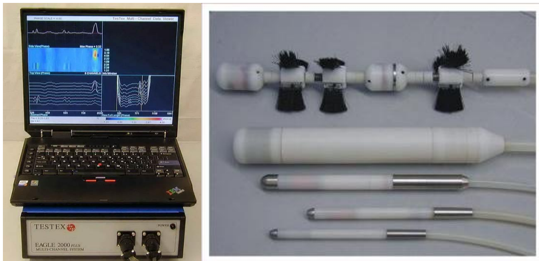
Kuva 4-13. RFET laitteisto putkiston tarkastukseen /Testex Incorporation/
