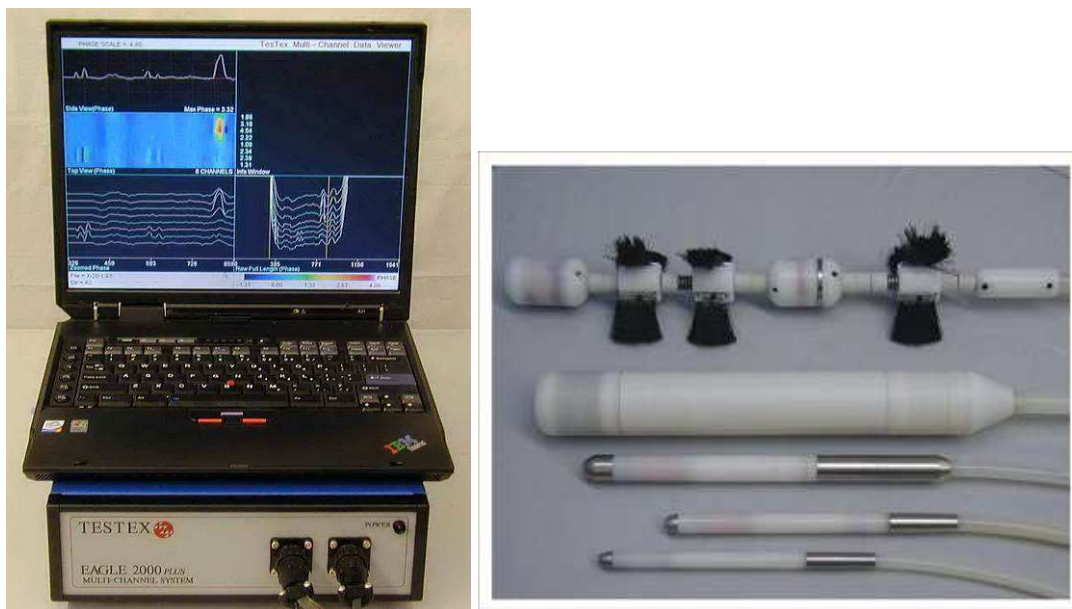
Kuva 11. RFET laitteisto putkiston tarkastukseen /Testex Incorporation/
