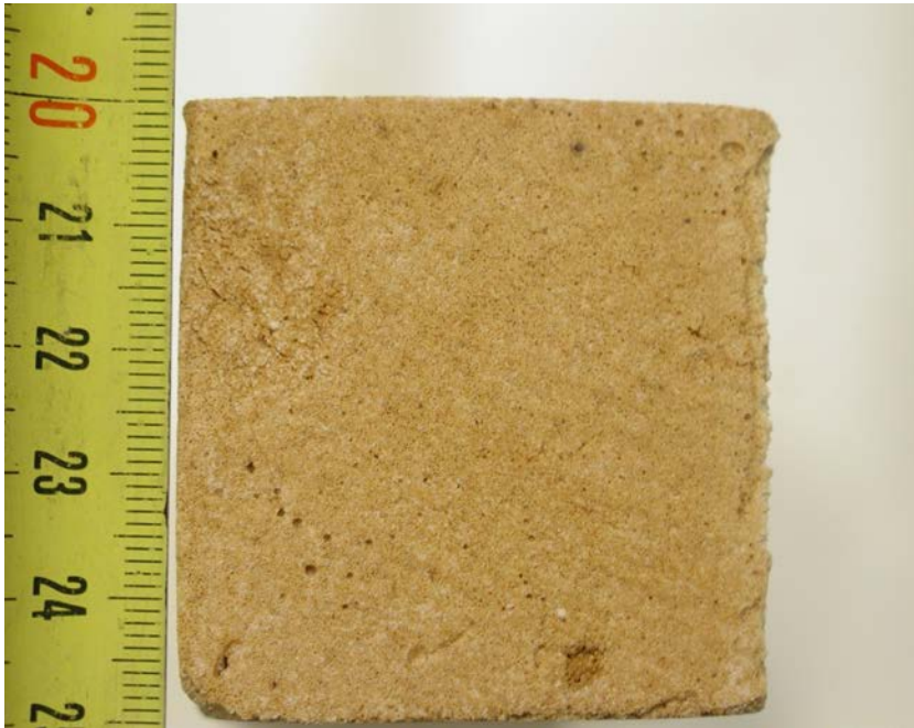
Kuva1. Oma massa kokeessa1. Syntetisoitu forsteriitti. Tehty kiinalaisesta magnesiasta ja nilsiän kvartsista. Sidokseen käytettiin kolloidista silikaa sekä puhdasta erittäin hienorakeista magnesiumoksidia. Synteesi tehty 1500°C 2h. Mittoja 50x50x150mm. Poltossa hieman käyrystynyt ja halkeillut.
