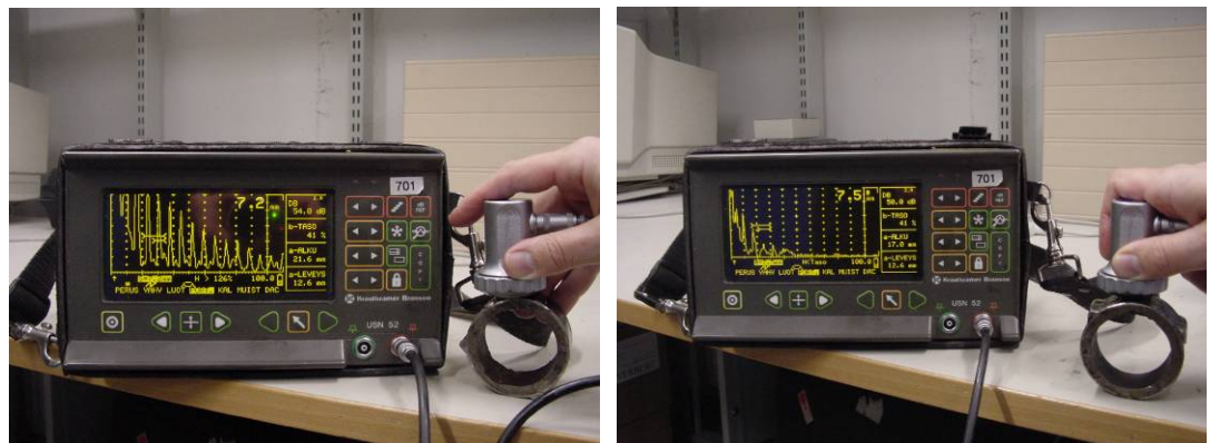
Kuva 8. A-näytöt ehjästä putkesta ja vetyhyökkäyskohdalta.
