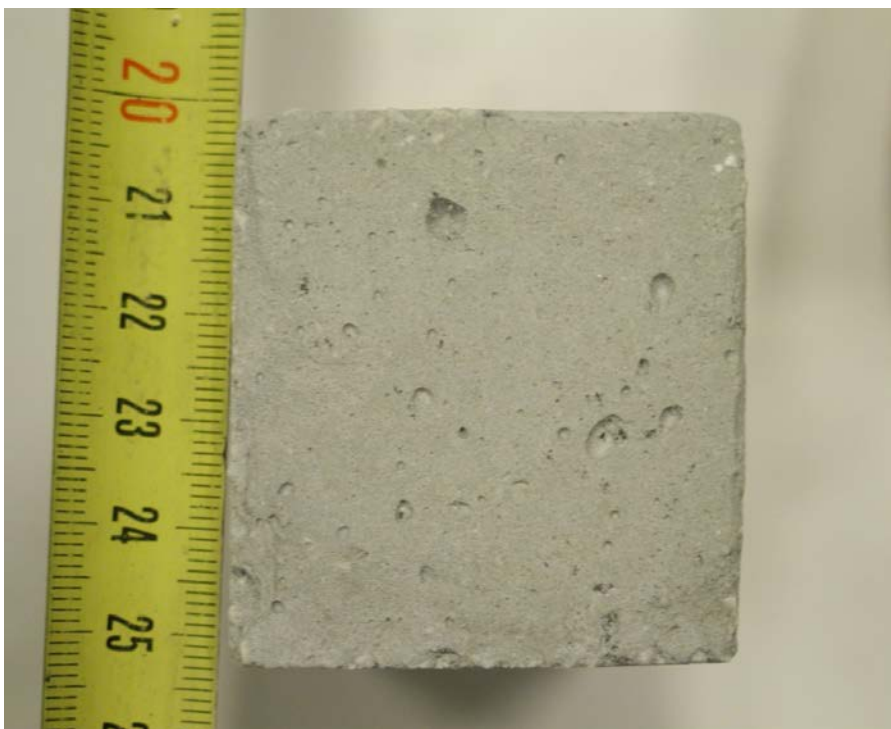
Kuva 4. Spinelliä muodostava massa SiC lisätty. Betker
