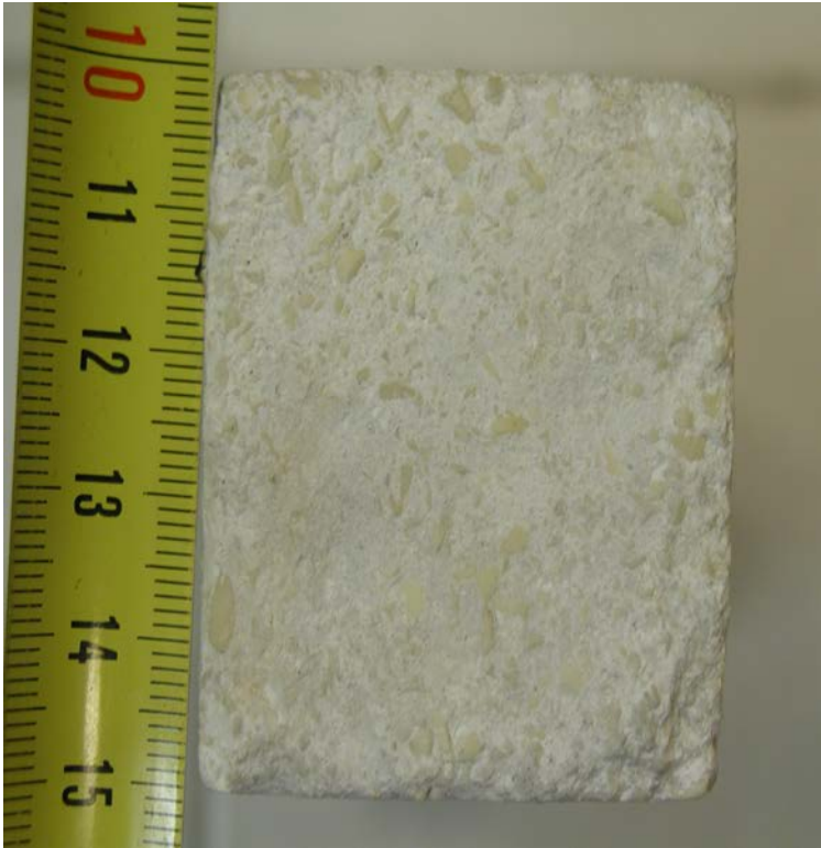
Kuva 8. Oma massa. Ankoflon isot rakeet on korvattu valmis spinelillä.
