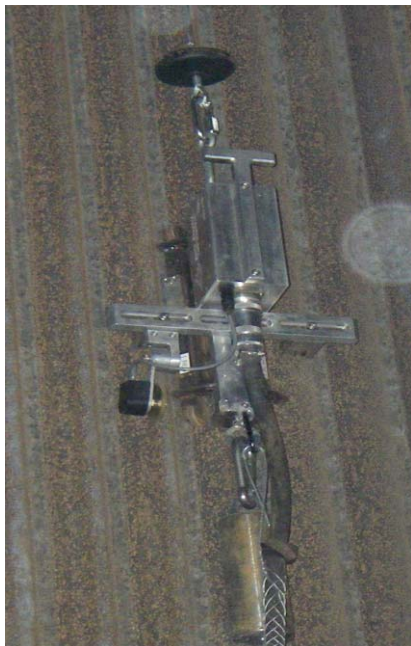
Kuva 6. T-scan laitteisto kattilan seinällä
