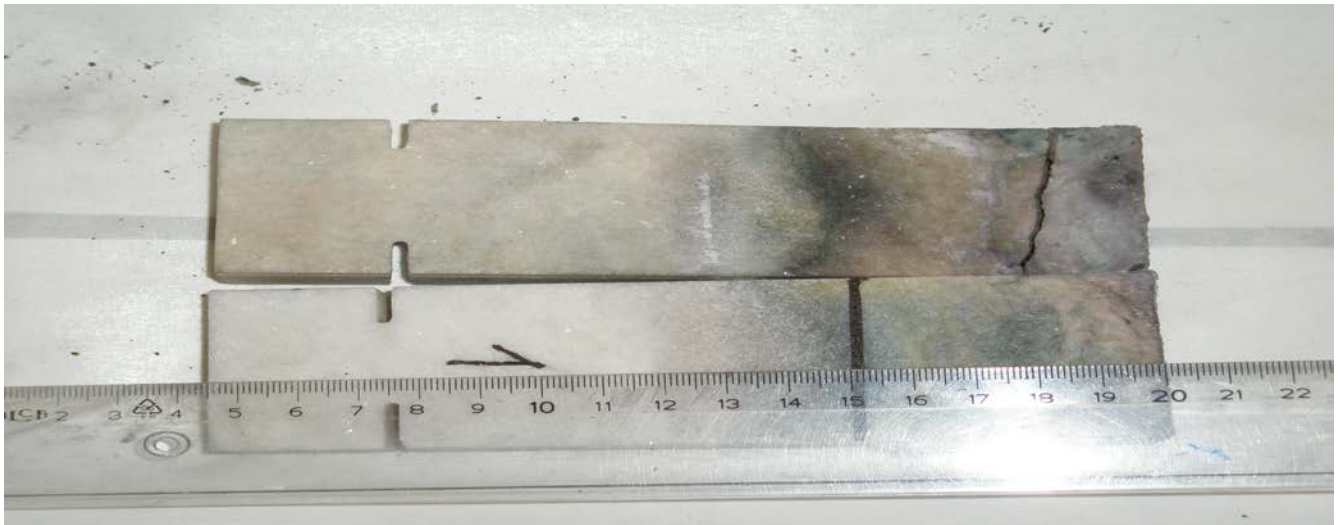
Kuva 1. Sulavalettu aloksitiili näyttää hyvältä päällepäin mutta sahatessa se halkesi ja soodakattilasulan on tunkeutunut melkein puoleenväliin tiiltä.
