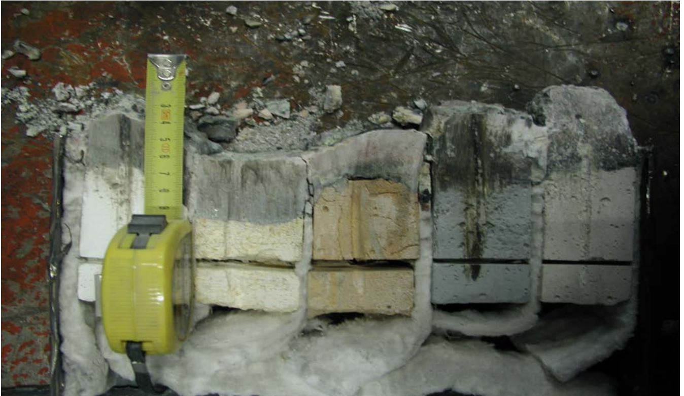
Kuva 3. Massoista parhaiten on pärjännyt alinna oleva hassle kuluma noin 10 mm. Seuraavana betker on jo huomattavasti enemmän kulunut. Siitä seuraava forsteriitti , ZrO_2 ja Ankoflo.
