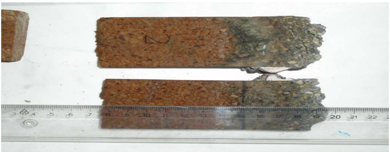
Kuva 2. MgO-rauta tiiliessä on joitain halkeamia ja sula on tunkeutunut noin 50 mm. Tiilen pinta on lohkeilleen näköinen.
