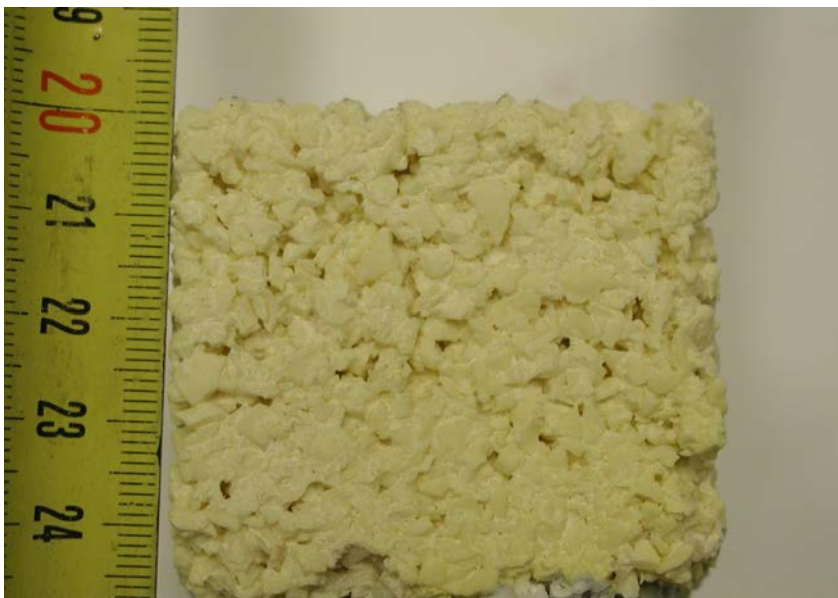
Kuva 2. Oma massa. Valmis-spinelliä magnesarikasta + \text{CeO}_2 + kalsiumaluminaattisementtiä 2%. 50x50x148mm
