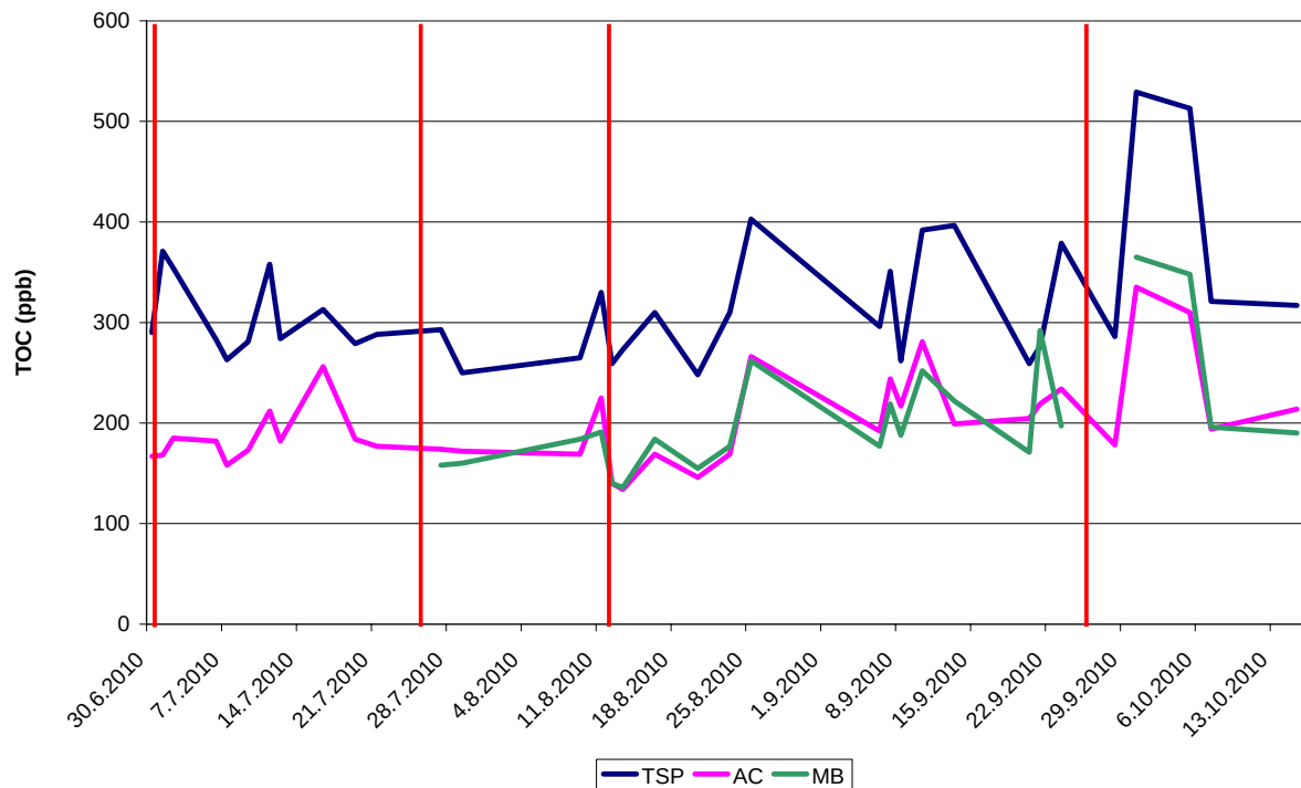
Kuva 7. Täyssuolapoistetun (TSP), aktiivihiilisuodatetun (AC) ja sekaionivaihdetun (MB) veden orgaanisen hiilen pitoisuudet koejakson (30.6.- 2.11.2010) aikana. Kuvaan on merkitty punaisilla pystyviivoilla aktiivihiilipatjan vaihdot.
