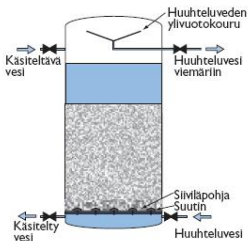
Kuva 35. Periaatekuva aktiivihiihliuodattimesta.
