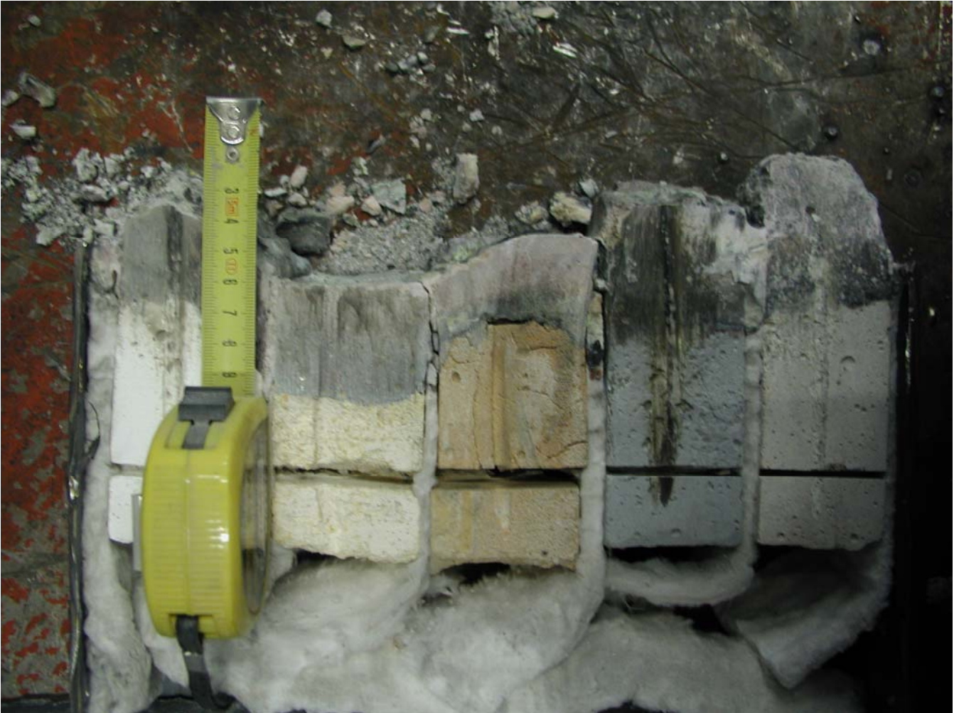
Kuva 8. Massoista parhaiten on pärjännyt alinna oleva hassle kuluma noin 10 mm. Seuraavana betker on jo huomattavasti enemmän kulunut. Siitä seuraava forsteriitti , ZrO_2 ja Ankoflo.
