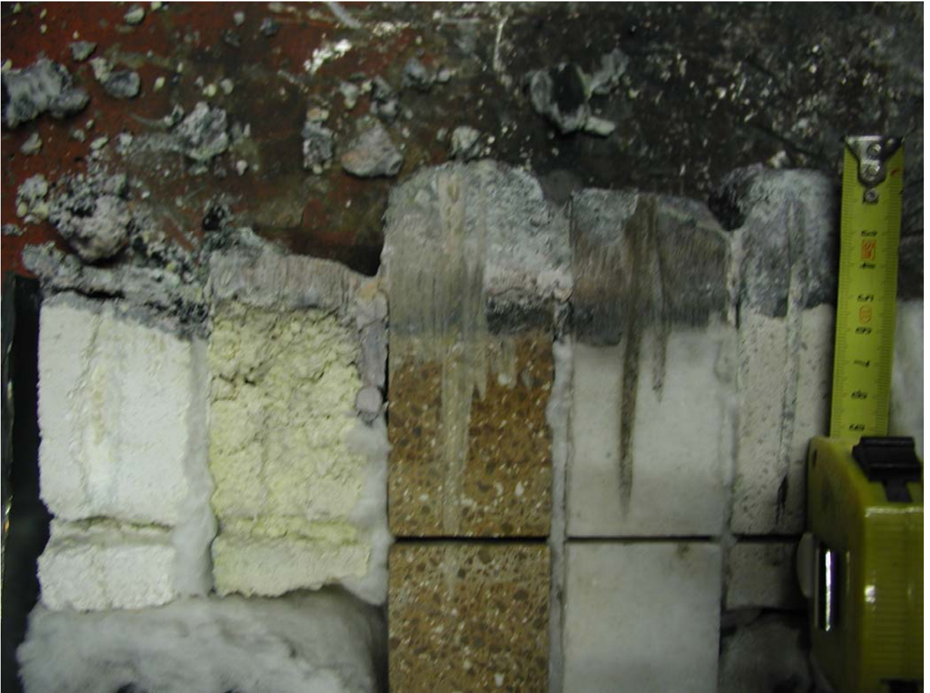
Kuva 9. Oikella oleva hasslen massa on pärjännyt MgO-rauta tiilen (keskellä) kanssa parhaiten. Niiden välissä oleva sulavalettu aloksi on heti kolmantena. Omavalmisteiset kellertävä CeO 2 lisätty ja spinelliä sisältävä massa pärjäsivät huonosti.
