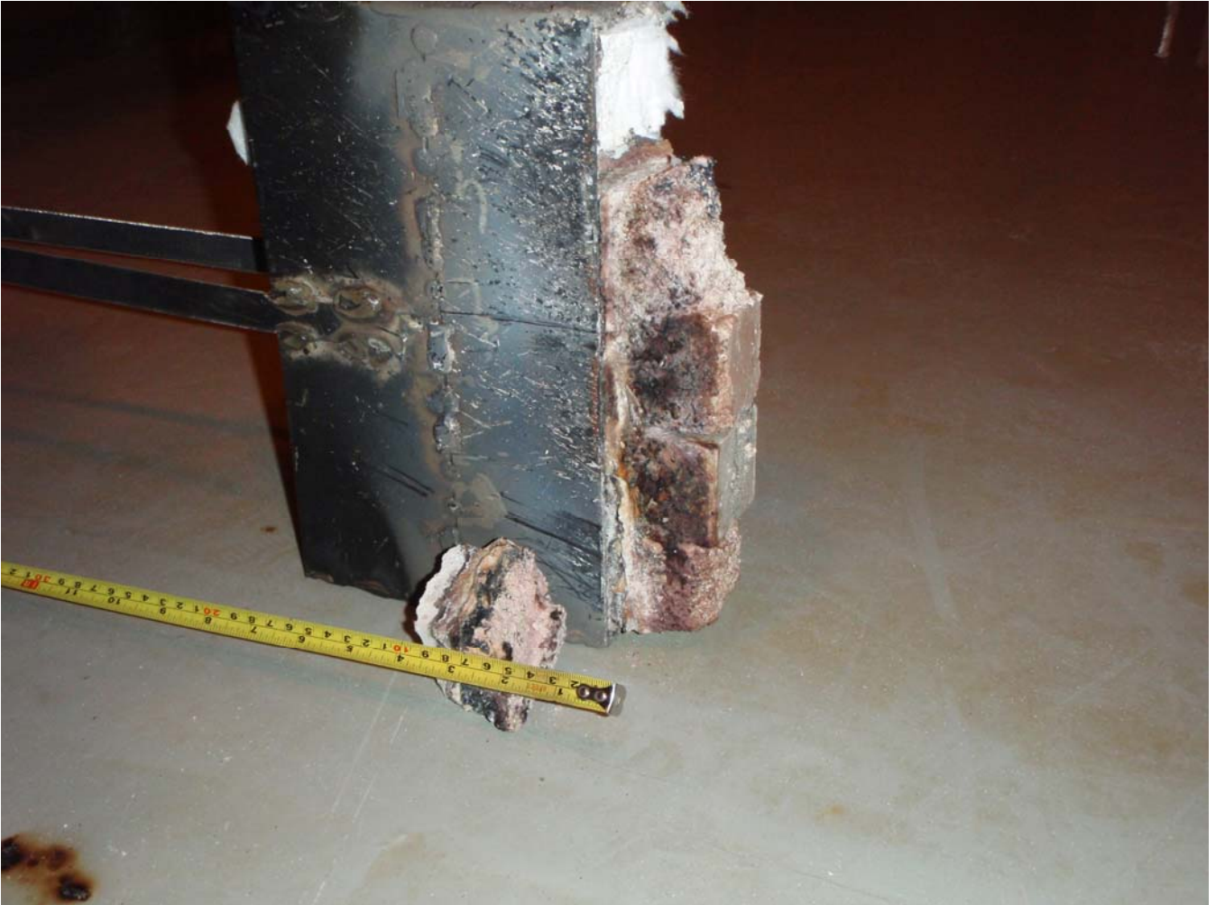
Kuva 6. Omatekoinen valmista spinelliä sisältävä massa ei ollut mekaanisesti tarpeeksi lujaa vaan katkesi kehikkoa irrotettaessa. Molemmat tiilet näyttävät hyviltä verattuna alinna vertailumateriaalina olevaan hasslen massaan.
