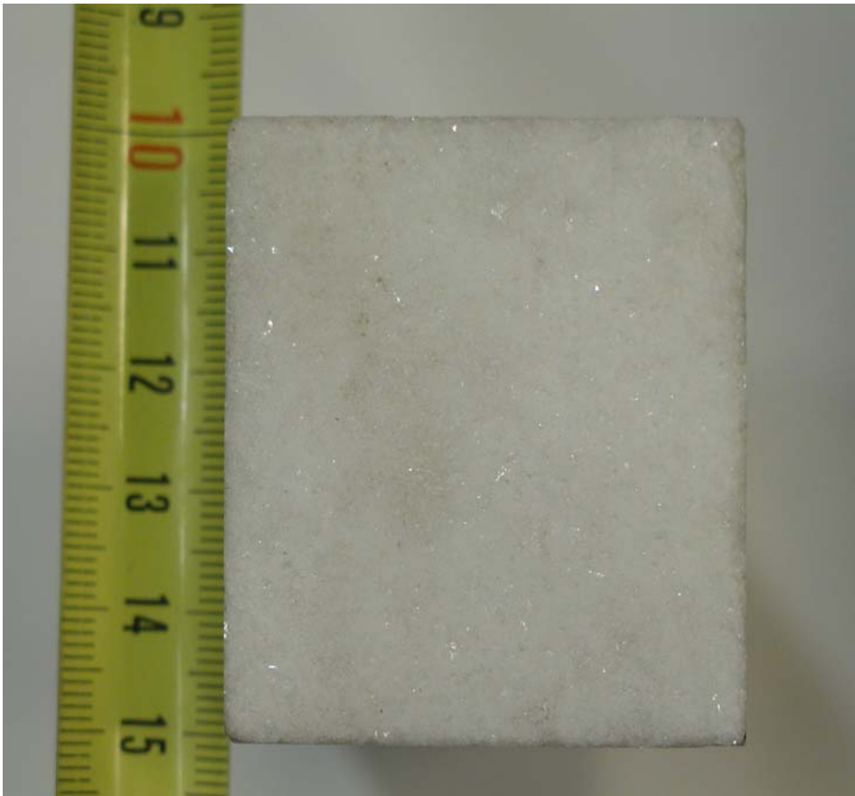
ZrO 2 massa. Sulavalettu aloksi.
