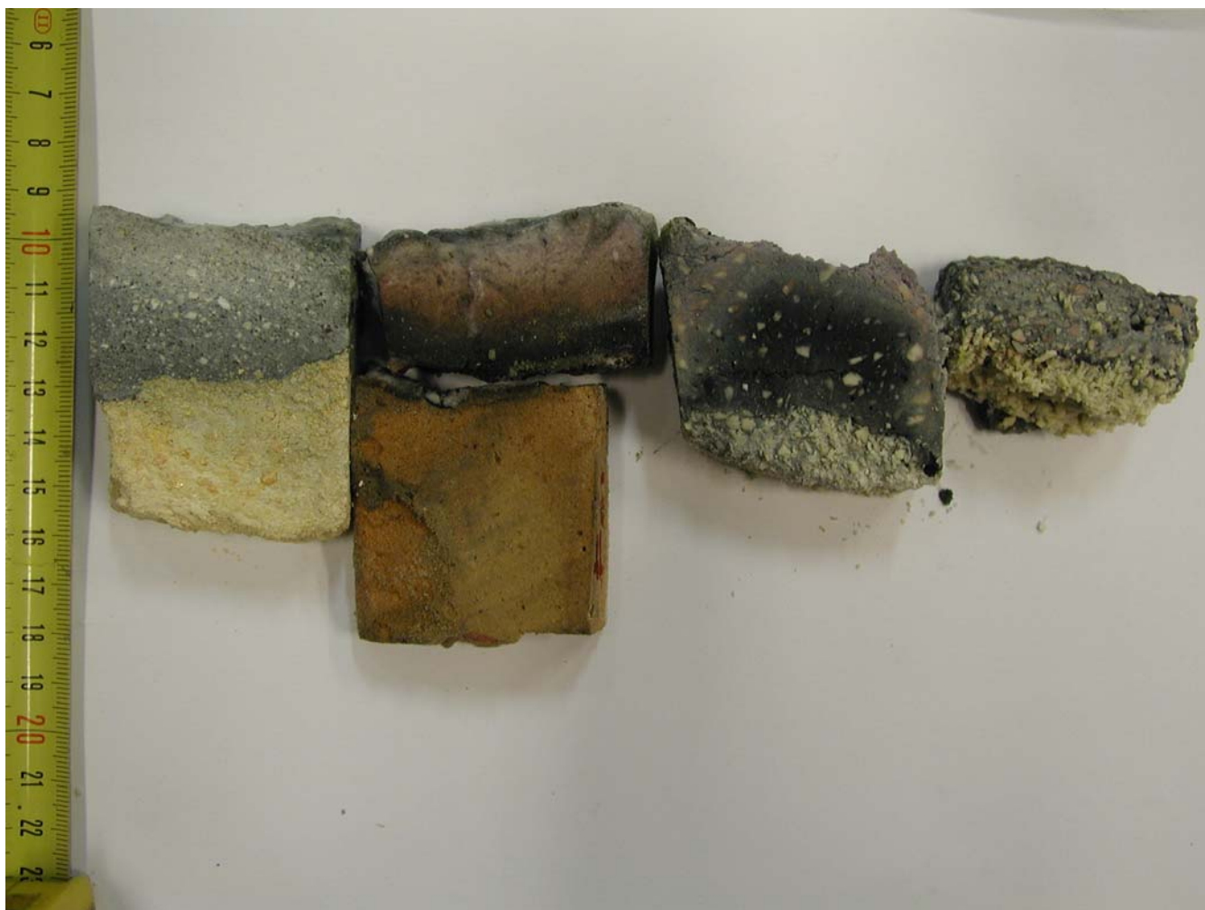
Huonoiten menestyneet kokoeen jälkeen leikkauspinta. Vasemmalta \text{ZrO}_2 , Forsteriitti, Spinelliä sisältävä ja \text{CeO}_2 . Ei paljon raportoivaa.
