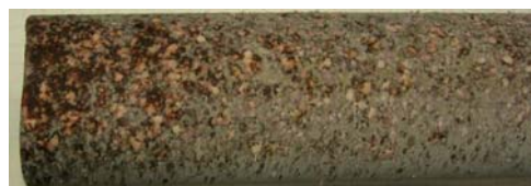
Kuva 3 Esimerkkikuvia kerrostumista jäähdyttämättömän sondin pinnalta a) kerrostumanopeus 3 mm/h ja b) kerrostumanopeus 8 mm/h.
