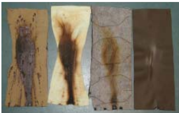
Kuva 9. 3-kerrosta ja tekoiho testin jälkeen
