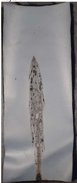
Päällä: Siloxane (TECVIN 440) Välissä: WOOLTECHS, 375 g/m 2 Alla: WOOLTECHS, 500 g/m 2 Näyte 1
