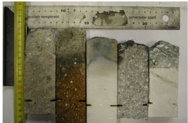
Kuva 1. Vasemmalta oikealle massat Hasle, MgO-rauta, sulavalettu alumiinioksidi, Betker ja AnkoFlo. [Oulun raportti 2010]
