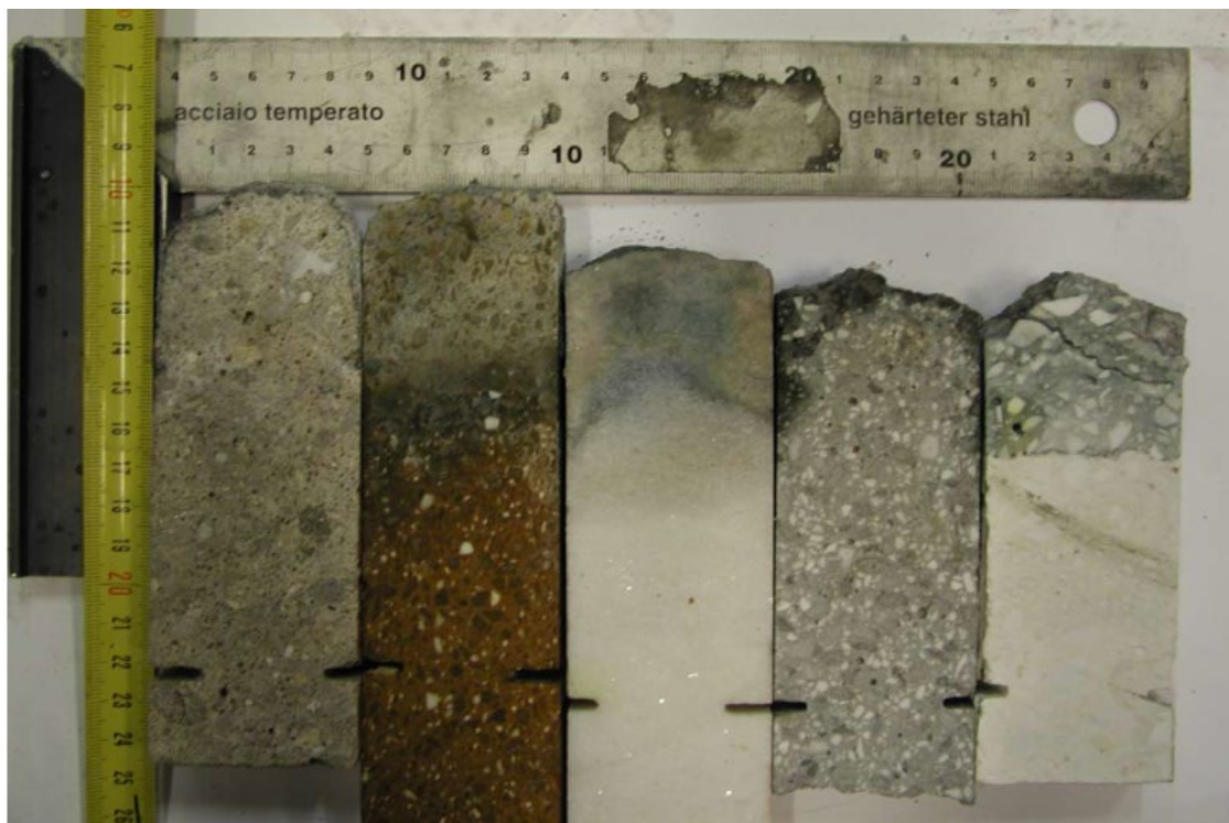
Kuva 2. Vasemmalta oikealle massat Hasle, MgO-rauta, sulavalettu alumiinioksidi, Betker ja Ankoflo. [Oulun raportti 2010]
