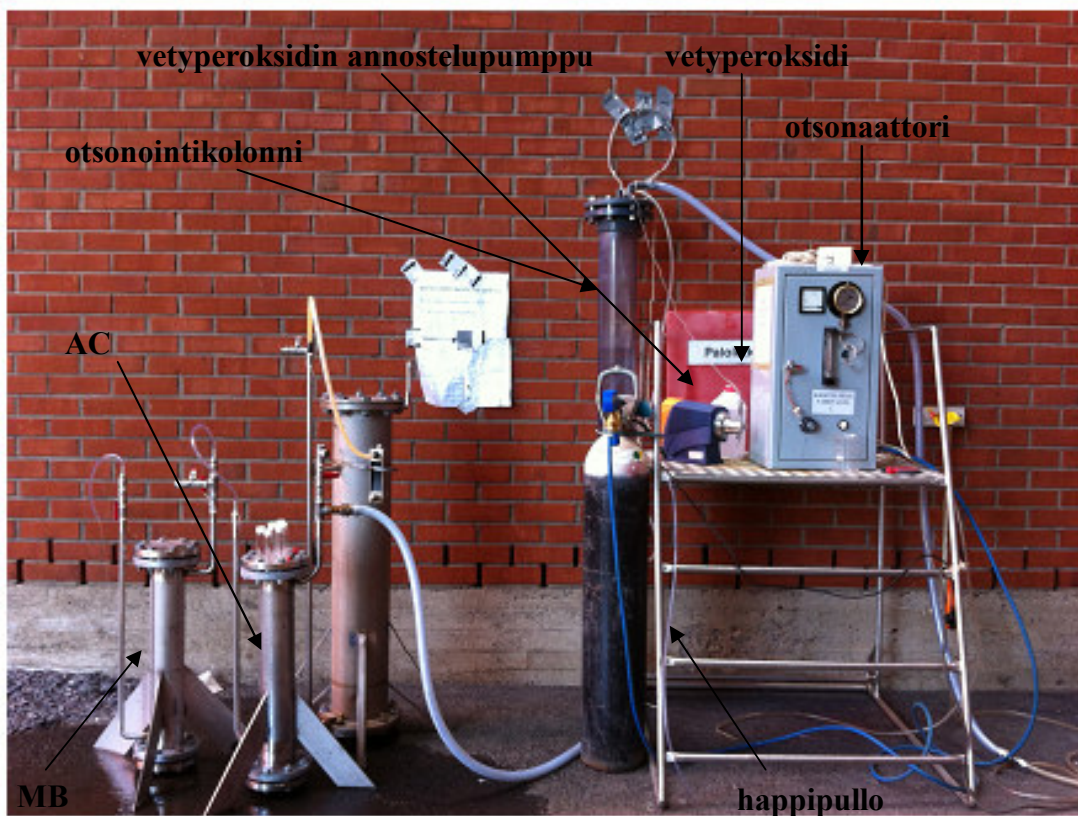
Kuva 3. Pilot-mittakaavan hapetus ja aktiivihiilisuodatuskokeiden laitteisto. Kuvassa MB = sekavaihdin, AC = aktiivihiilisuodatin.
