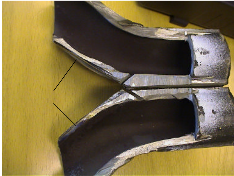
Kuva 6 Ilma-aukon taivutukset, viat nuolien kohdalla
