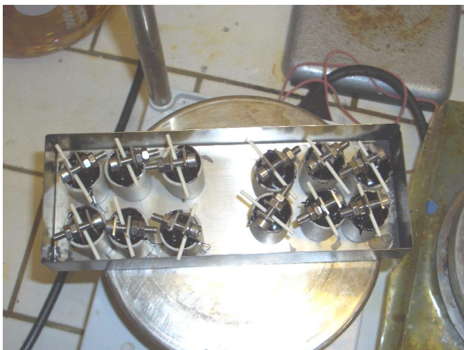
Kuva 40. U-sauvat alumiinioksidipokkaissa rst-laivassa valmiina uunitukseen.
