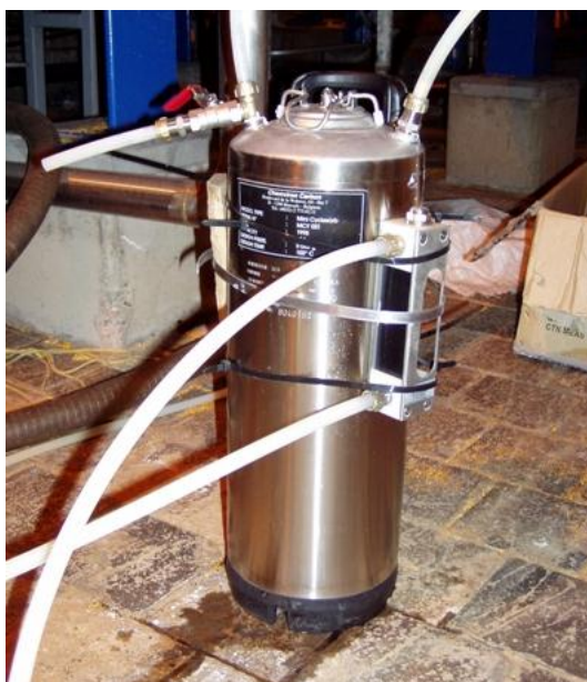
Kuva 2. Vasemmalla: Mini-Cyclesorb MS20 -suodatinyksikön rakenne ja veden virtaus (merkitty nuolilla). 2 Oikealla: Suodatin toiminnassa.
