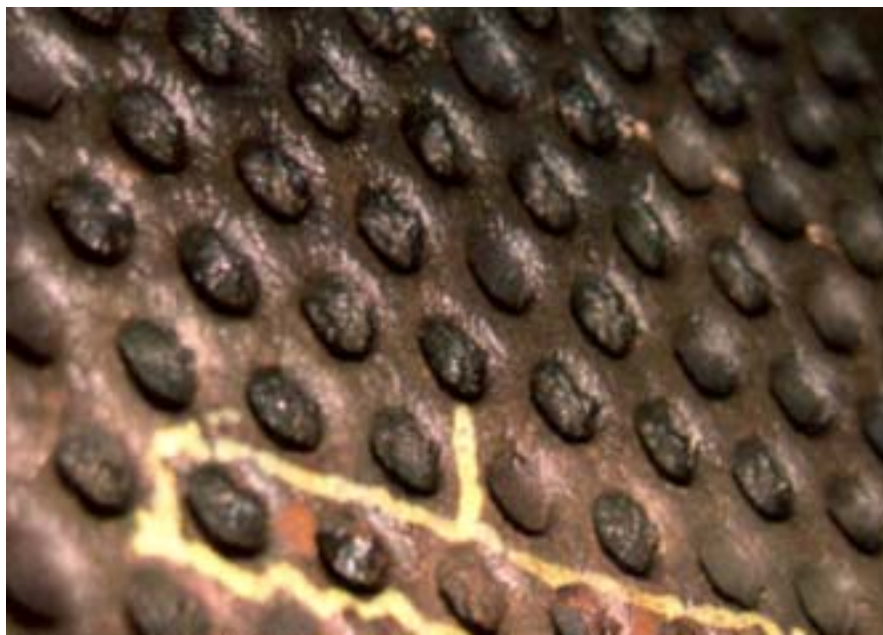
Kuva 10. Moneypointin laitoksen korkeapaine-esilämmittimen päätylevy ennen vesikemiassa tehtyjä muutoksia.
