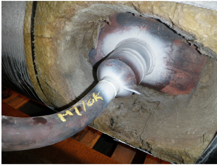
Syöttövesiyhteen magneettijauhetaarkastus
