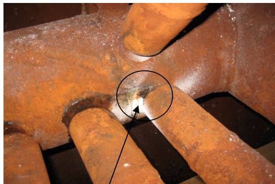
Vuotokohta eri kuvakulmasta. Kattila paineistettiin 10 bariin, pistemäinen vesisuihku ei erotu kuvassa.
