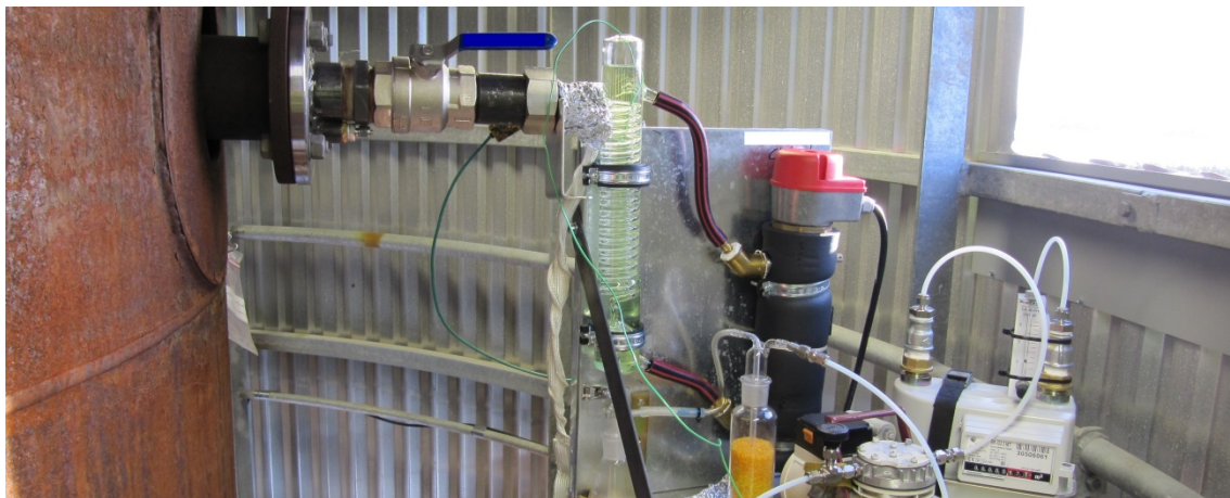
Figur 15. Mätning med kontrollerad kondensationsutrustning i Obbola.
