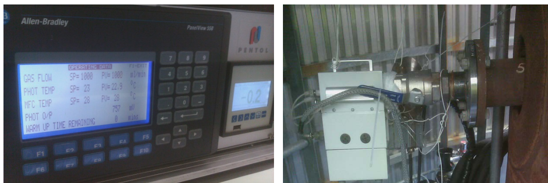
Figur 16. Mätning med Pentols online-instrument. Styrenheten till vänster och sondenheten till höger (en stor del av sonden är i pannan).
