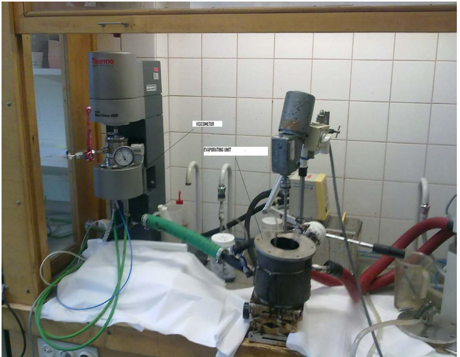
Kuva 3. Viskositeettimäärittämiseen käytetty laitteisto kokonaisuudessaan
