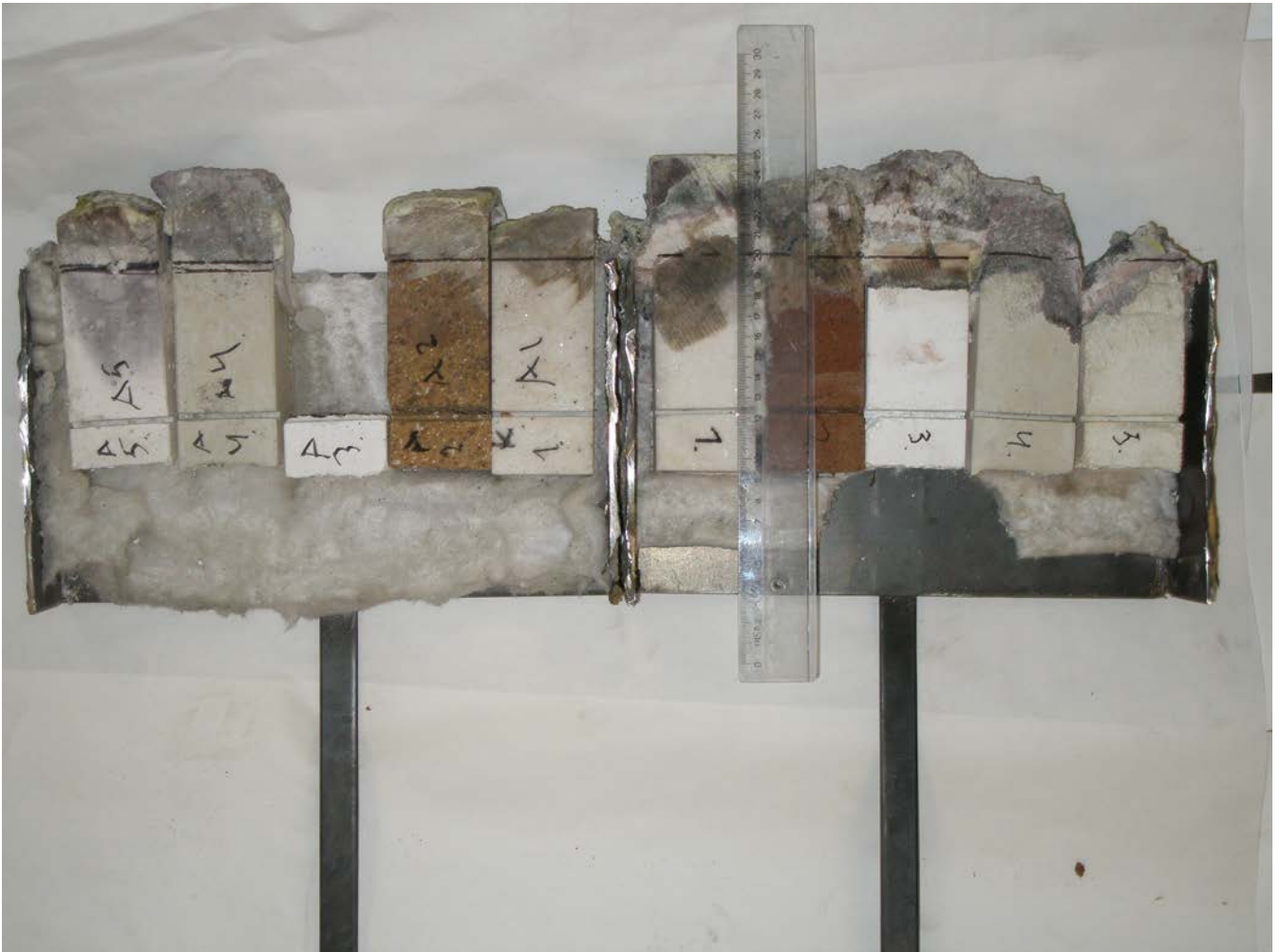
Kuva 7. Koekappaleet kokeen 2 jälkeen. Huomataan aika erilaiset kulumiset kattilan eri puolilla samoilla koemateriaaleilla. Nro 1 ja 3 ovat parhaimman näköiset toisessa ja A4 toisessa kehikossa.
