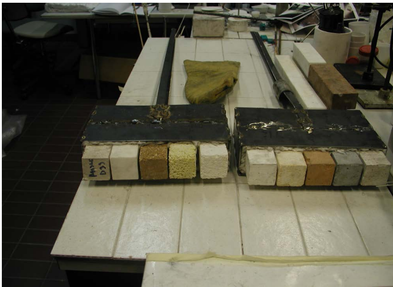
Kuva 1. Molemmat valmiit kehiöt. Kappaleiden ulkonema oli 50 mm.
