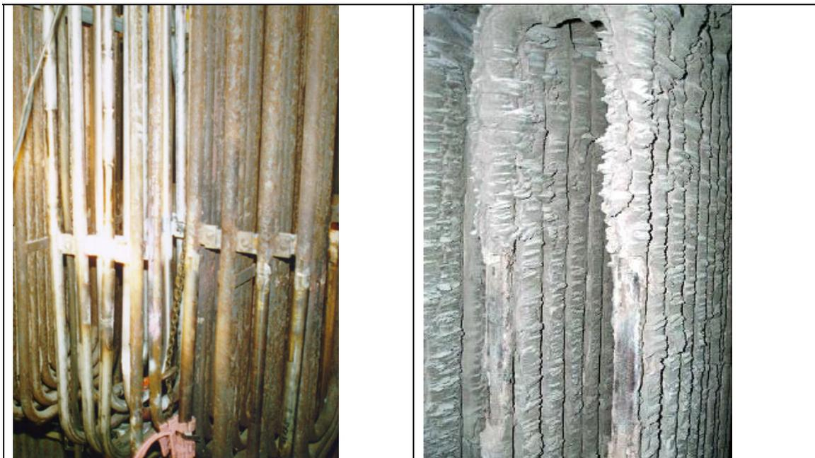
Figur 20. Testslungan och delar av ÖH2 före drift (vänster) och efter en eldningssäsong (höger) [17]
