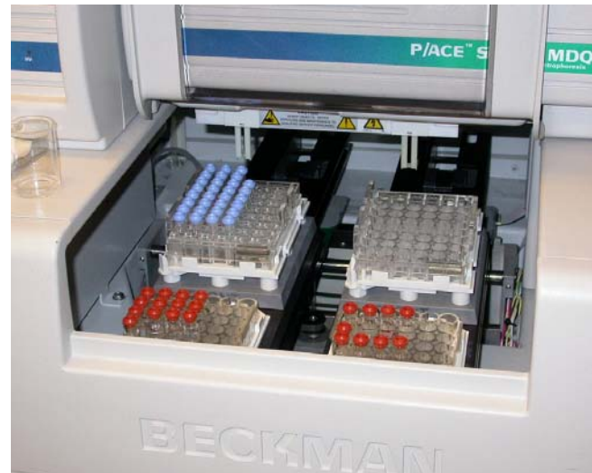
Kuva 4 Tutkimuksessa käytetty Beckman-Coulterin kapillaarielektroforeesilaitte (vasemmalla) ja näytteen syöttörobotti (oikealla).
