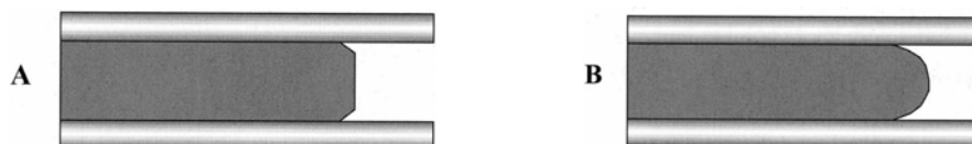
Kuva 3 (A) Tylppä virtausprofiili (elektroforeesi). (B) Parabolinen virtausprofiili (kromatografia).
