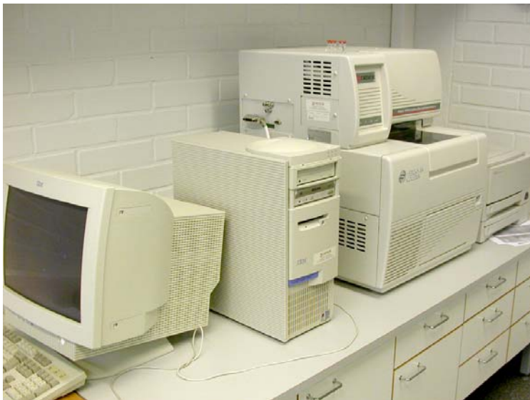
Kuva 4 Tutkimuksessa käytetty Beckman-Coulterin kapillaarielektroforeesilaitte (vasemmalla) ja näytteen syöttörobotti (oikealla).
