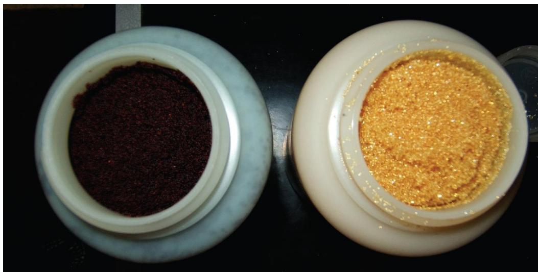
Kuva 30. Suolapestyn (oikea) ja orgaanisesti likaantuneen (vasen) hartsin välillä saattaa olla hyvinkin selkeä värierö (23).
