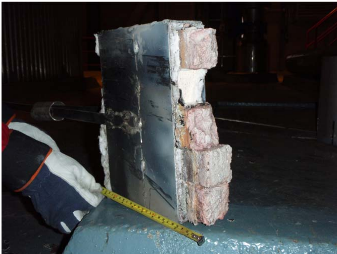
Kuva 5-6. Tulenkestävät massat kokeen jälkeen
