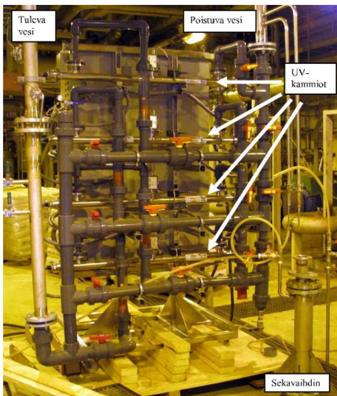
Kuva 5-16. UV-kokeissa käytetty pilot-laitteisto
