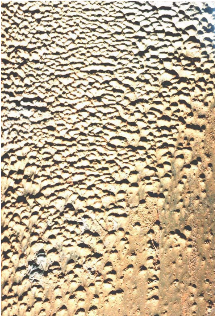
Kuva 36. Virtauksen kiihdyttämän korroosion (FAC) tyypillinen ulkonäkö. Virtaussuunta alhaalta ylöspäin [48]
