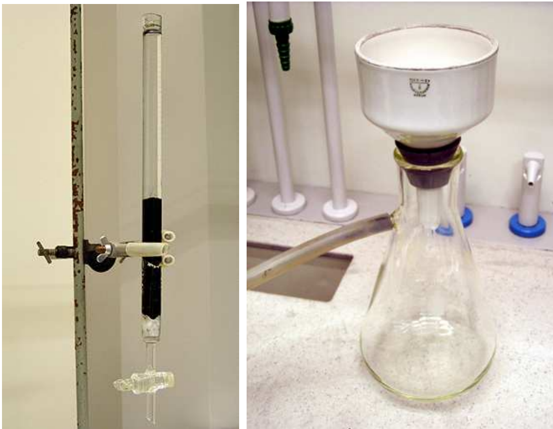
Kuva 35. Laboratoriomittakaavan aktiivihiilikokeissa käytetyt koejärjestelyt. Vasemmalla byrettityyppinen putki, jossa aktiivihiilipatja. Oikealla imusuodatusvälineet.
